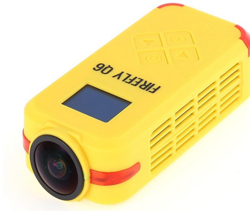
Figura 5.7: Cámara Firefly Q6 [23]
