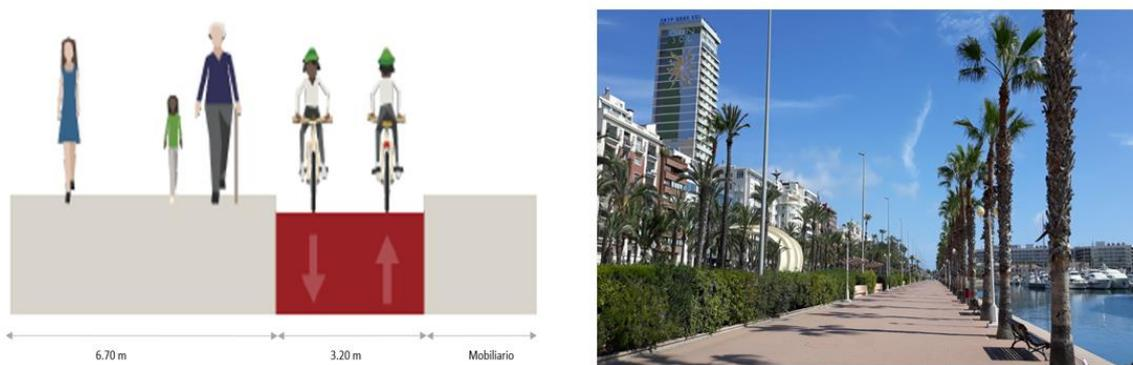
Figura 76: Sección tipo de la conexión playa Postiguet-centro. Fuente Ayuntamiento Madrid - elaboración propia
