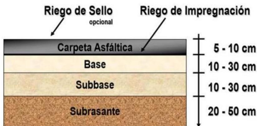
Figura 61: Diseño del firme, pavimento bituminoso existente tramo 7. Fuente: cámara nacional del cemento
