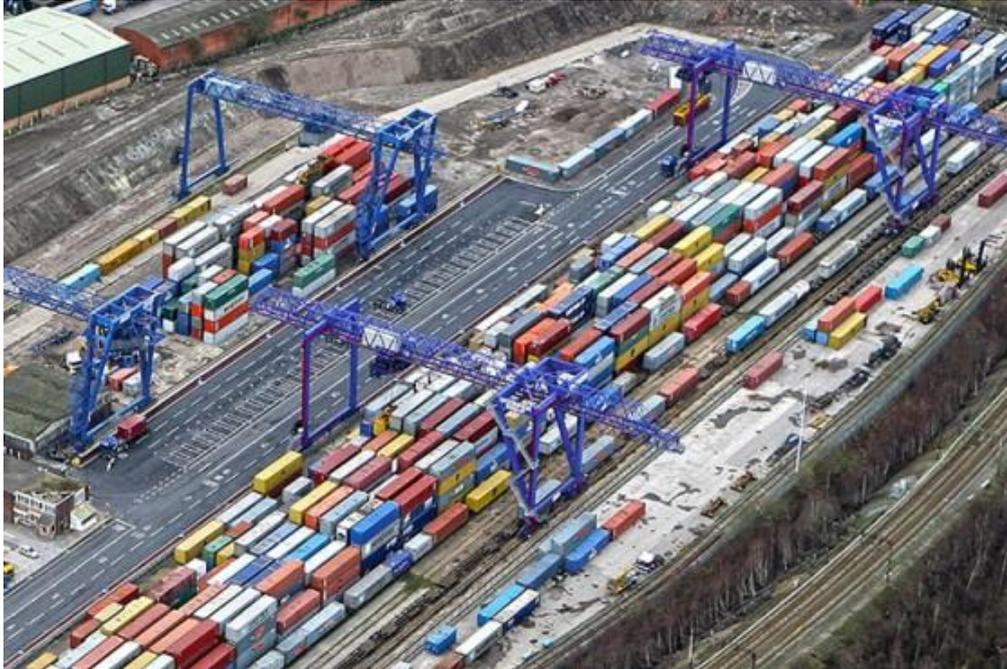
Figura 9 – Rail Mounted Gantry. Fuente: Grúas apiladoras de contenedores sobre raíles, s.f.
