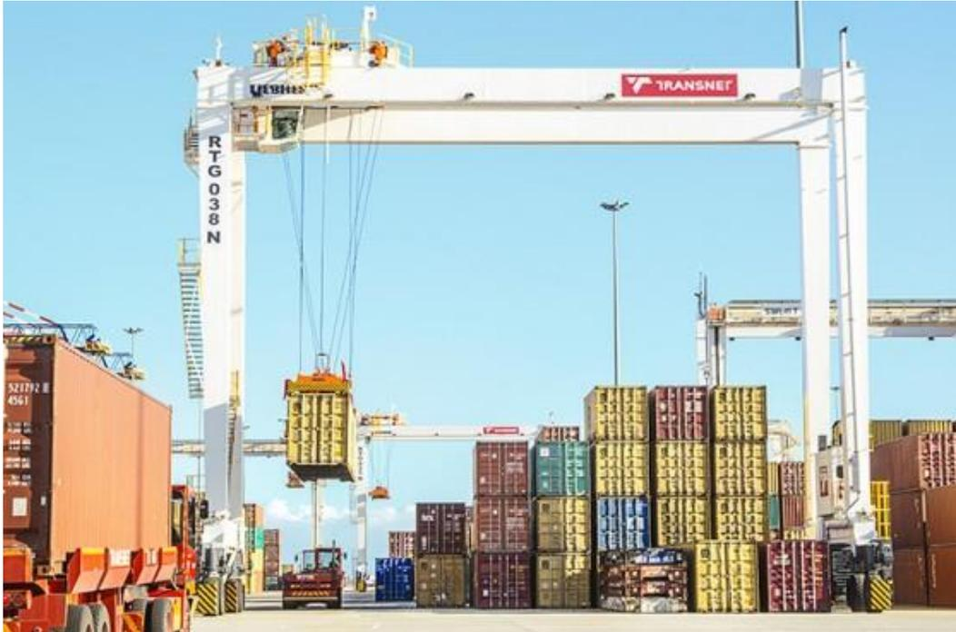
Figura 6 - Rubber Tyred Gantry. Fuente: Grúas apiladoras de contenedores sobre neumáticos, s.f.
