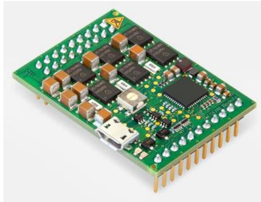
Es aparente a primera vista que el único tipo de conexión de la que dispone esta etapa (aparte del puerto microUSB mediante el que configura) de potencia son tres filas de pines estándar, de modo que para conectarlas a los motores o a la placa microcontroladora será necesaria una placa de circuito o conectores especiales.
