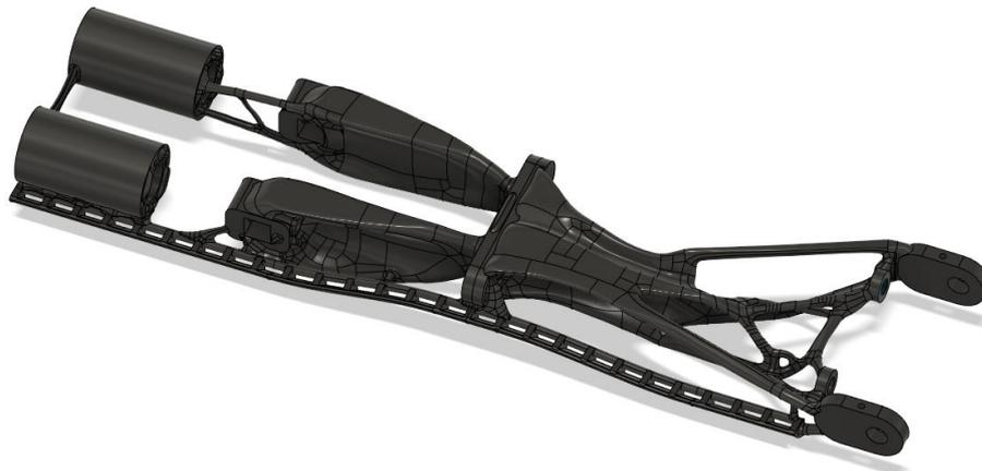
Ilustración 45: Diseño antebrazo con eje ranurado
