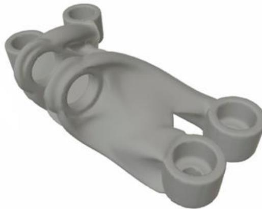
Ilustración 31: Ejemplo de resultado final de diseño generativo
