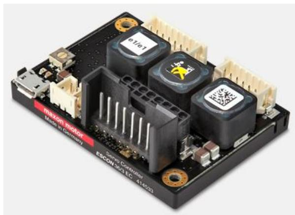
A diferencia de las anteriores, estas etapas de potencia sí que cuentan con una carcasa de protección y conectores que facilitan el conexionado entre la ESCON y los motores y controladora
