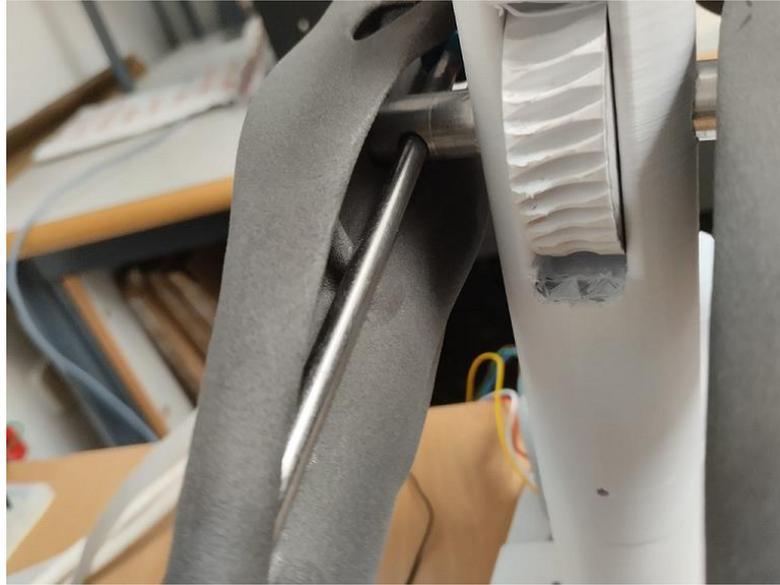
*Ilustración 36: Junta cillíndrica formada por eje de la primera articulación y eje de transmisión de potencia de 2ª/3ª articulación*
