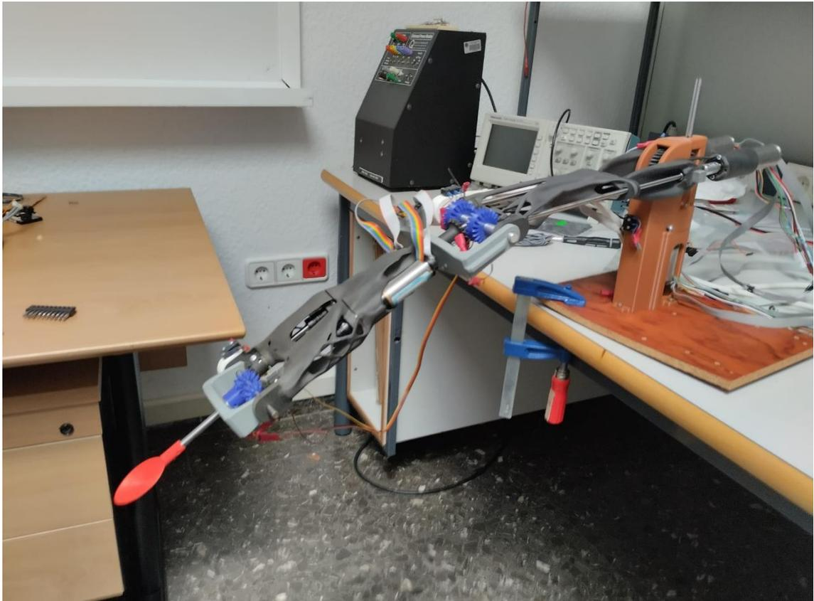
*Ilustración 54: Barzo robot completo, con cableado y fines de carrera*
