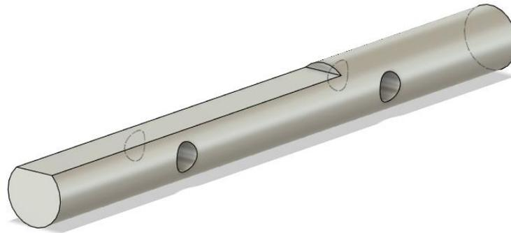
*Ilustración 32: Eje del hombro de diseño anterior del brazo robot*
