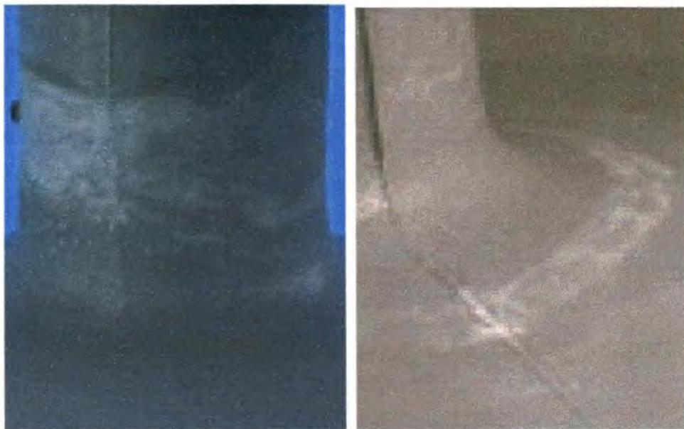
Figura 7. Daños producidos en la superficie de un aislador polimérico por el efecto de Dry bands [38].
