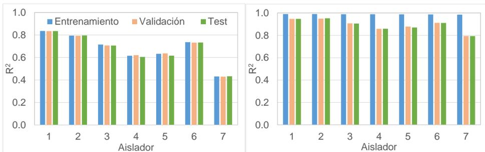
Figura 100. R<sup>2</sup> promedio de los modelos de predicción de la corriente de fuga a partir de variables ambientales mediante el modelo 2IL-CNN. Izquierda: Muestras actuales. Derecha: Las últimas 21 muestras.
