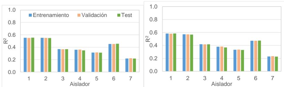
Figura 73. R<sup>2</sup> promedio de los modelos de predicción de la corriente de fuga a partir de variables ambientales mediante MVR. Izquierda: Muestras actuales. Derecha: Las últimas 21 muestras.
