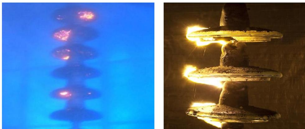
Figura 8. Proceso de descarga disruptiva en aislador cerámico. Izquierda: Descargas parciales [39]. Derecha: Descarga disruptiva del aislador cuando la corriente de fuga incrementa por encima de su límite debido a los depósitos de contaminación (extraído de [27]).
