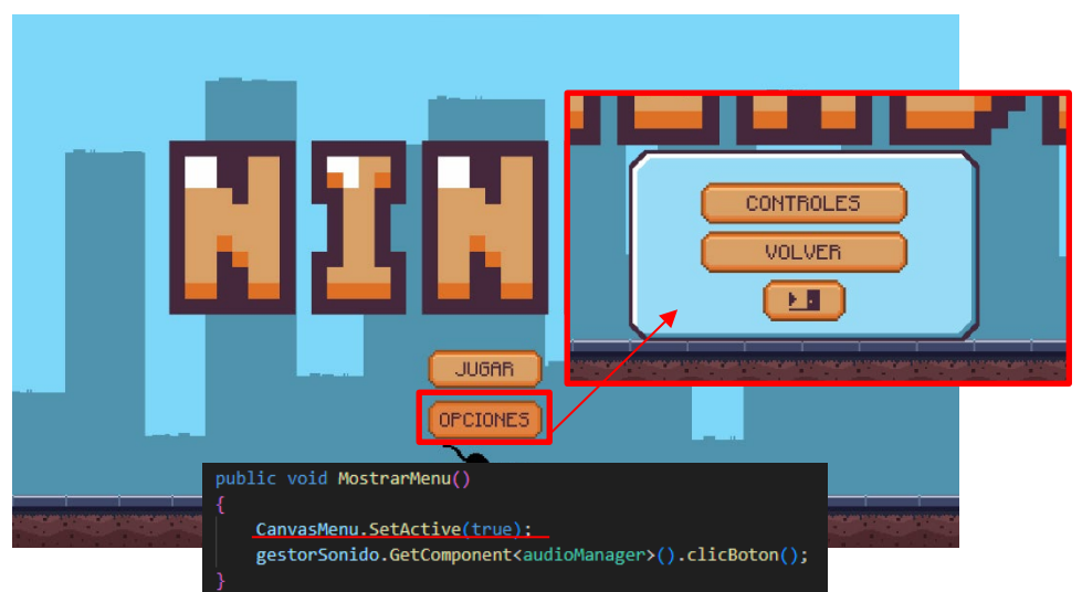
Imagen 58: ejemplo de cómo está programado un botón, en este caso el botón de opciones de la portada del juego.
