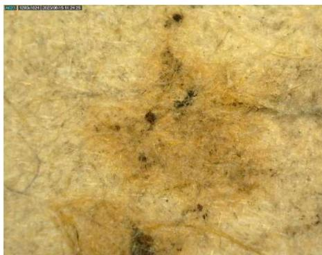
*Fig.9: Detalle de una mancha de oxidación en el reverso del documento tomada con el Dino-lite.*
