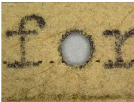
*Fig.8: Detalle de la zona donde la máquina de escribir se llevó parte del soporte por la presión ejercida.*
