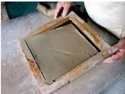
Figura 9. Tipo de molde de madera en la elaboración de un "socarrat".
