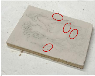
Figura 29. Estallido de burbujas en la elaboración de un socarrat.
