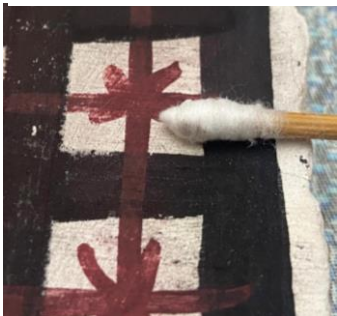
Figura 32. Después de hornear la loseta, se retira menos pigmento.
