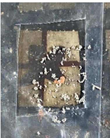
Figura 49. Limpieza con Sponge eraser donde se pueden observar pequeñas partículas de color blanquecino.
