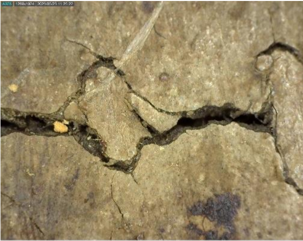
Figura 50. Macrofotografía detalle grietas de envejecimiento en la costura, Dino-lite digital microscope 50x
