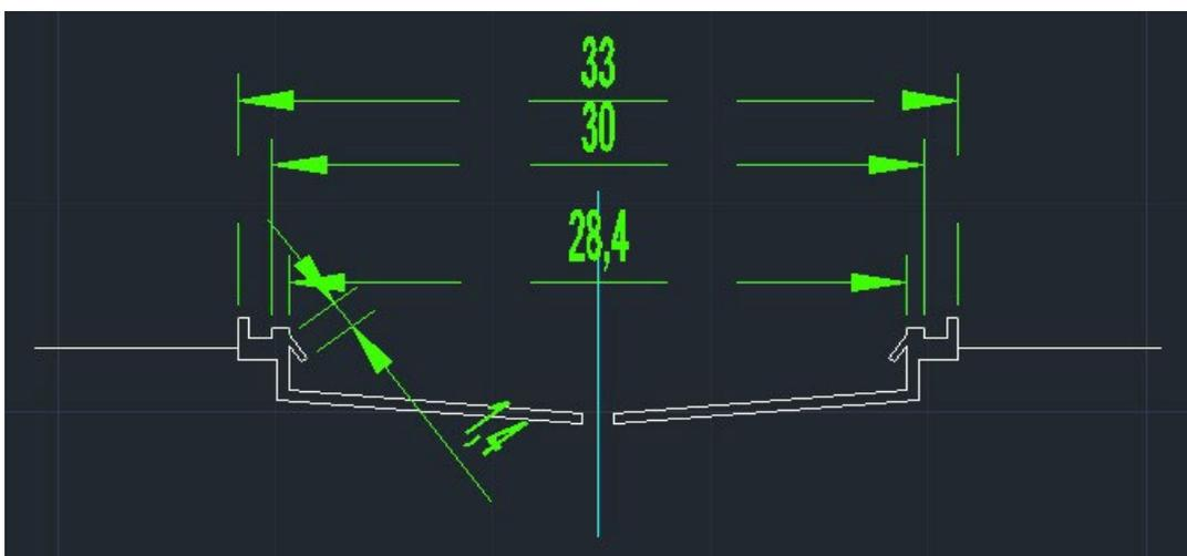
Figura 9. Sección transversal de un decantador primario en el esquema A/O. Elaboración propia.
