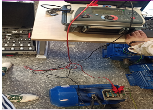
Figura 61: Conexiones para prueba de IP con un motor eléctrico
