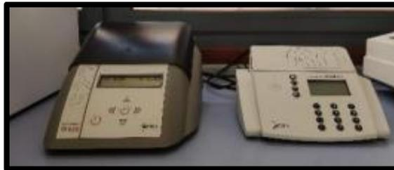
*Figura 29: Termorreactor y espectrofotómetro para la medida de la DQO*
