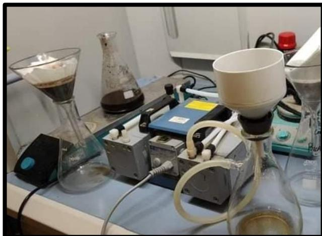
Figura 32: Montaje experimental: Bomba de vacío y matraz y embudo Büchner
