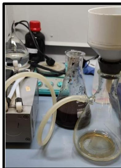
Figura 33: Embudo y matraz Büchner
