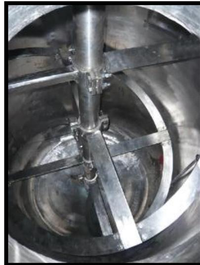
Figura 58: Agitador en espiral
