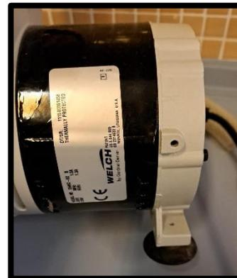
Figura 23: Motor bomba de vacío
