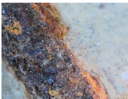
Figura.21: Fotografía microscópica de una zona de oxidación de las grapas.
