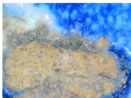
Figura.20: Fotografía microscópica de una zona de descorchado del esmalte.
