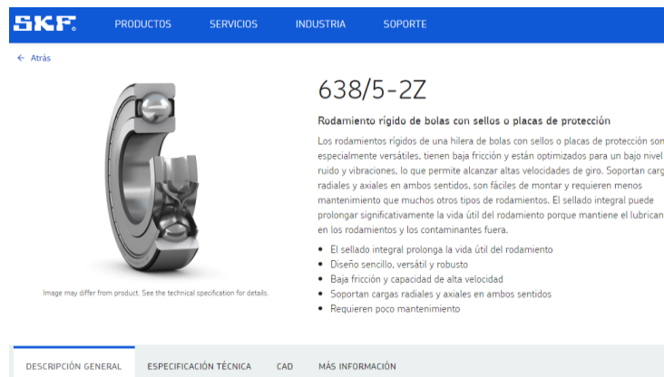
Ilustración 76 Característica básicas del rodamiento SKF 628/5-2Z (Fuente 79)
