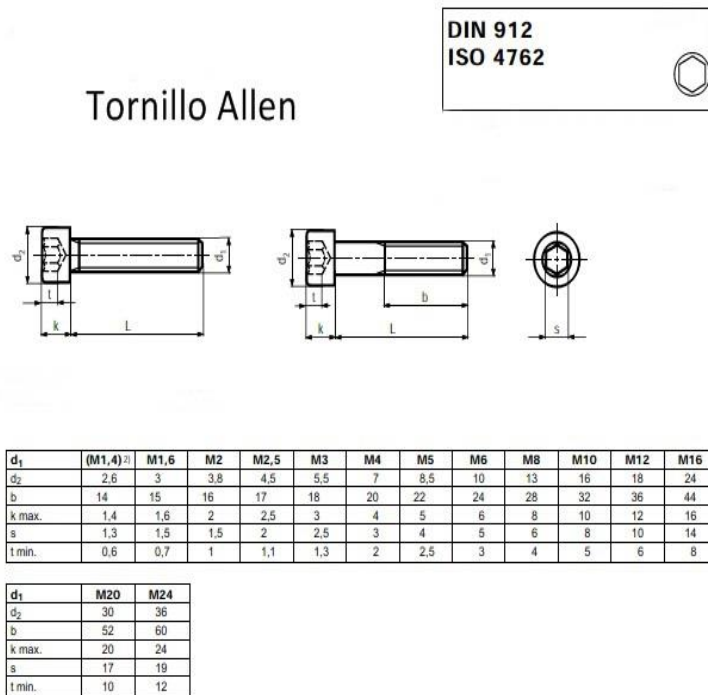
Ilustración 66 Normativa de pernos DIN 912 (Fuente 69)
