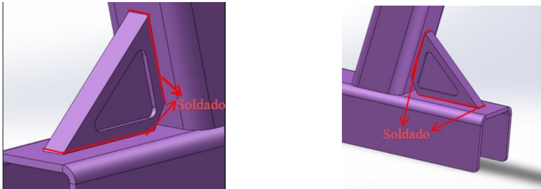
Ilustración 80 Vistas de soldado de cuñas de pieza N°1 (Fuente 85)
