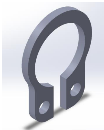
Ilustración 70 Modelaje del circlip para cojinetes SKF 628/5-2Z (Fuente 73)
