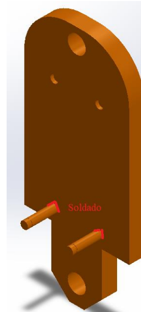
Ilustración 92 Vista de soldado de pieza N°9.2 (Fuente 97)
