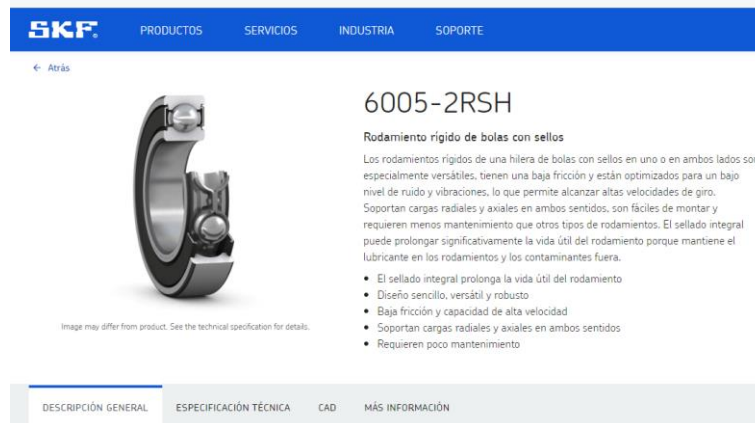
Ilustración 75 Característica básicas del rodamiento SKF 6005-2RSH (Fuente 78)
