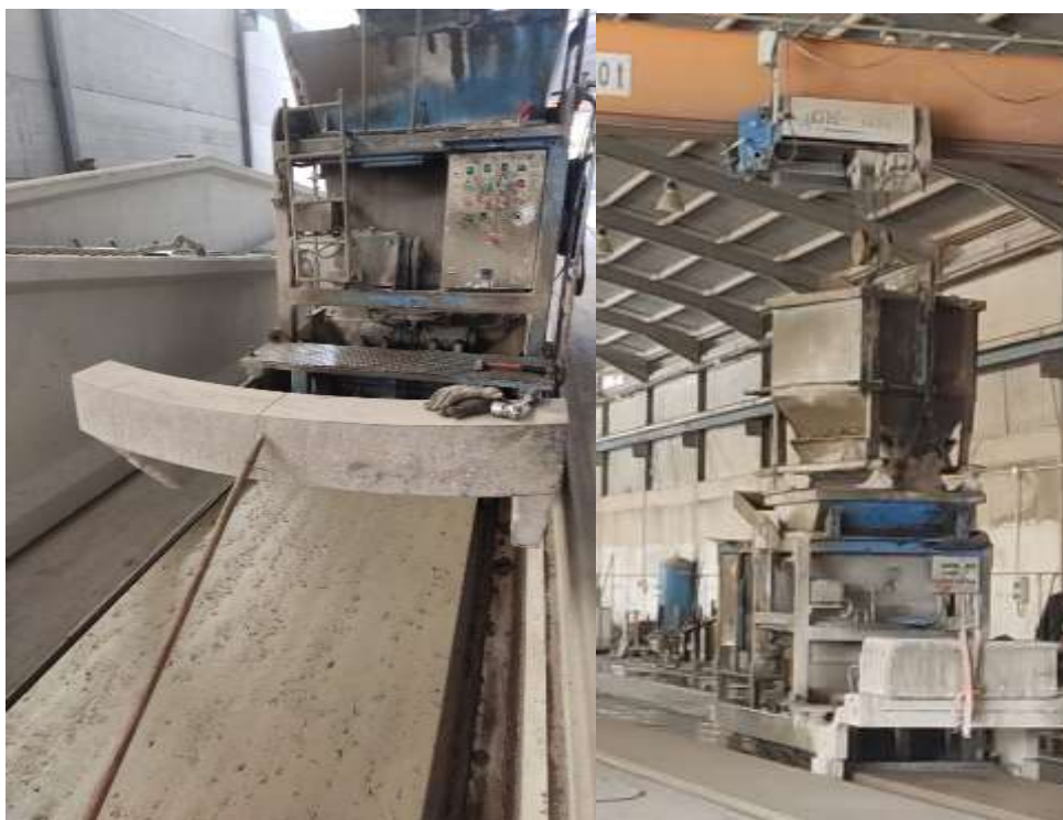
Ilustración 19. Máquina moldeadora de losas alveolares. Fuente: Propia.
