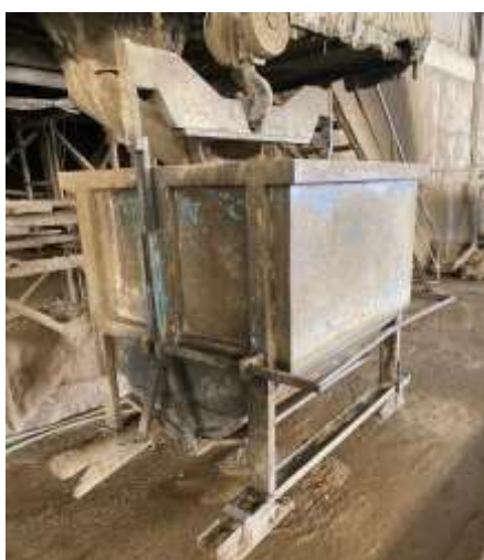
Ilustración 12. Cubilote de hormigonado.
