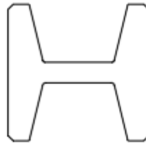
Detalle 8. Viga portacanalón.
