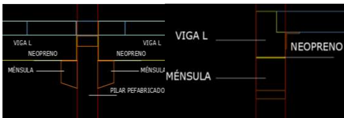
Detalle 11. Unión viga – pilar con ménsula
