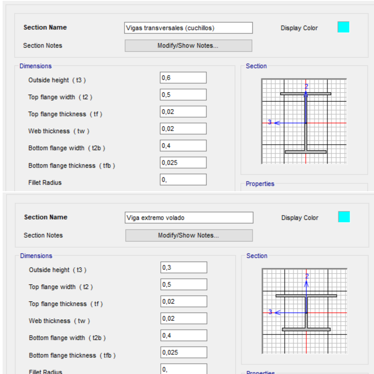
Imagen 16. Secciones cuchillos SAP2000 (Fuente: Elaboración propia)
