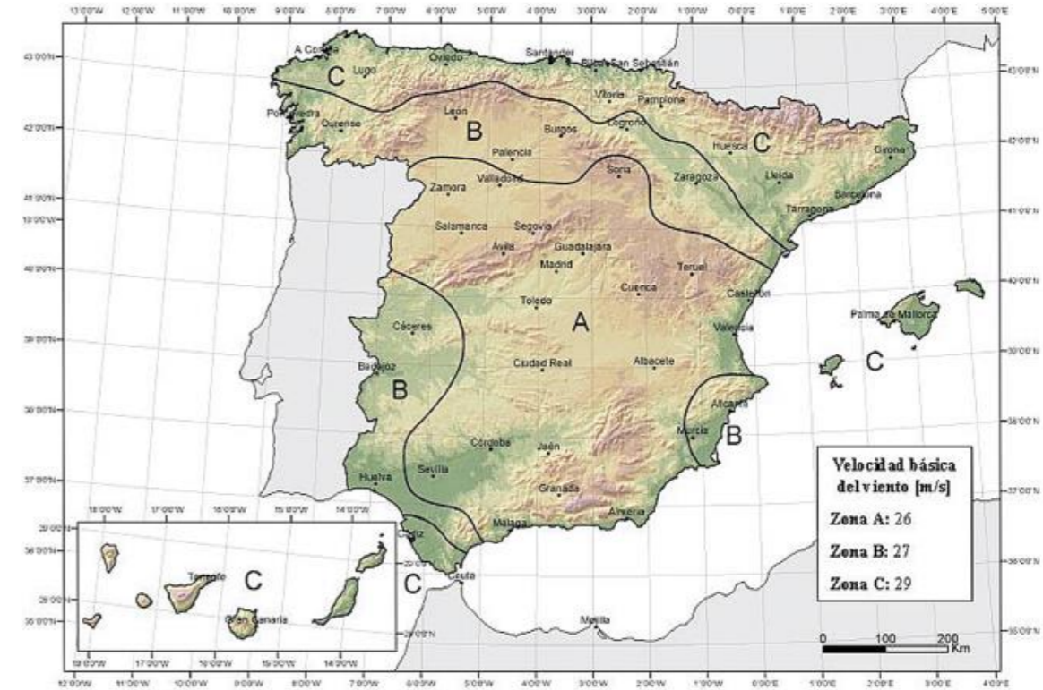
Imagen 9. Mapa isotacas para la obtención de V_{b,0} (Fuente: IAP-11)
