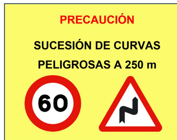
Figura 3. Cartel retrorreflectante de precaución en el p.k. 171+620 del tramo de estudio (Fuente: Elaboración propia)
