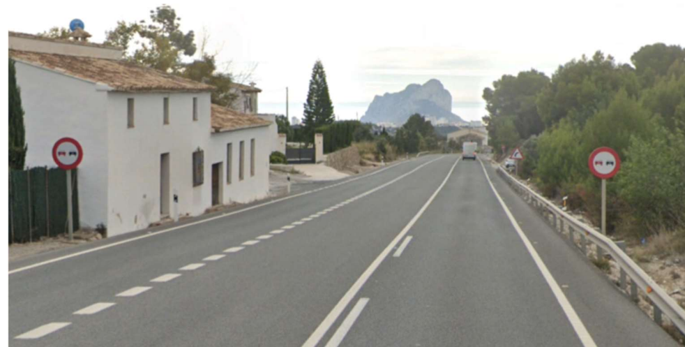
Figura 14. Indicación de la prohibición de adelantamiento en el p.k. 174+440 del tramo de estudio (Fuente: Elaboración propia)
