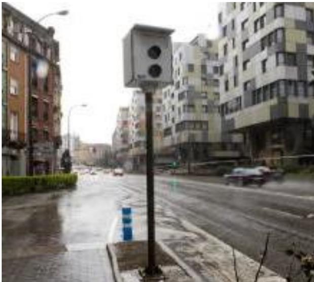
Figura 18: Radar de microondas. (Fuente [16])
