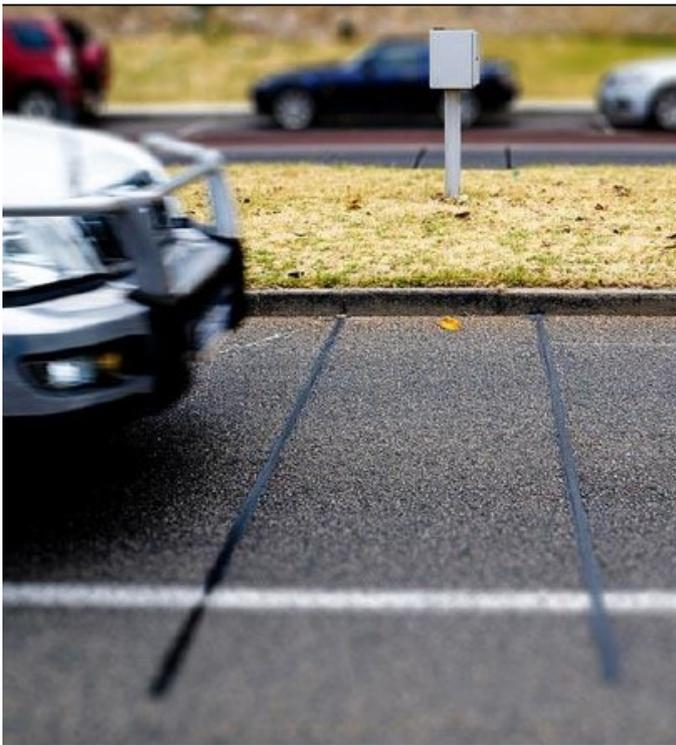
Figura 12: Sensor piezoeléctrico dual. (Fuente [16])
