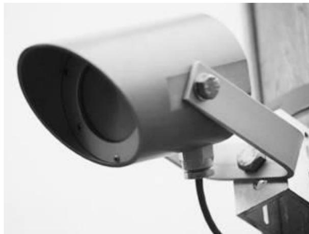
Figura 20: Sensor infrarrojo pasivo. (Fuente [16])
