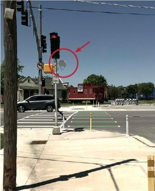
Figura 37: Radar de microondas en una intersección de Huntsville, AL. (Fuente [15])
