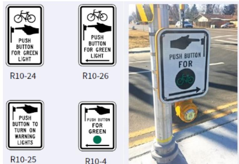
Figura 29: Diseño pulsadores ciclista según MUTCD. (Fuente [15])
