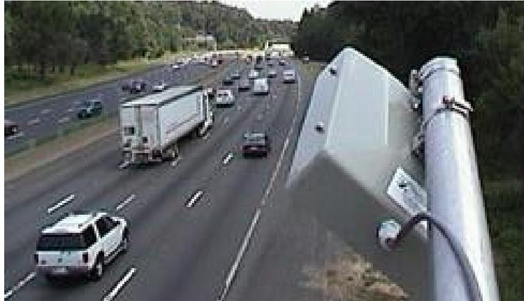
Figura 17: Sensor acústico pasivo. (Fuente [16])
