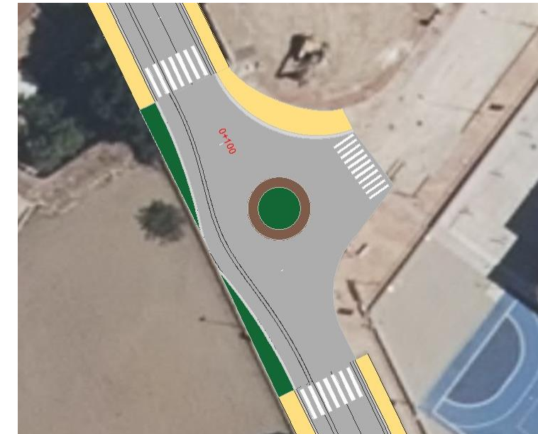
Figura 8. Punto 1 coincidente con la glorieta situada en el PK 0+100. Fuente: Elaboración propia
