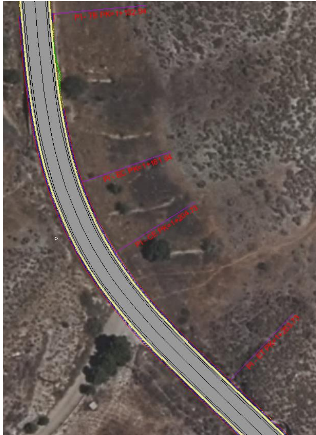
Figura 15. Acondicionamiento curva 3 entre PK 1+132 y PK 1+254. Fuente: Elaboración propia
