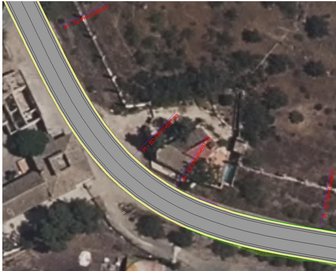
Figura 12. Acondicionamiento curva 1 entre PK 0+550 Y PK 0+649. Fuente: Elaboración propia
