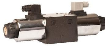
(b) Electrovalvula 4/3 con posición de centro "P-T" y retorno por muelle pilotada a 110 V ac, puesta en carga para alimentación de la línea
