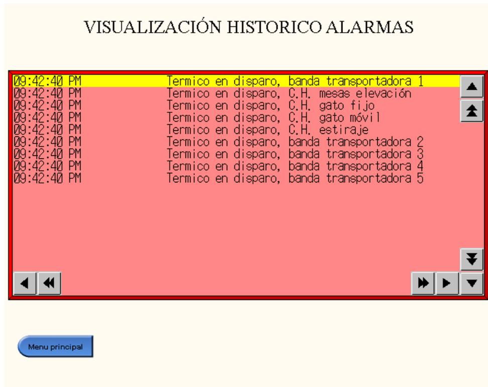
**Figura 3.48:** Interacción hombre/máquina desde HMI, visualización de alarmas
