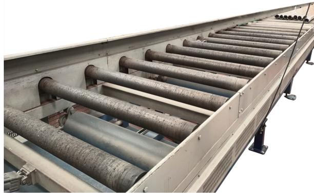
Figura 2.5: Mesa de rodillos con elevación en sierra
