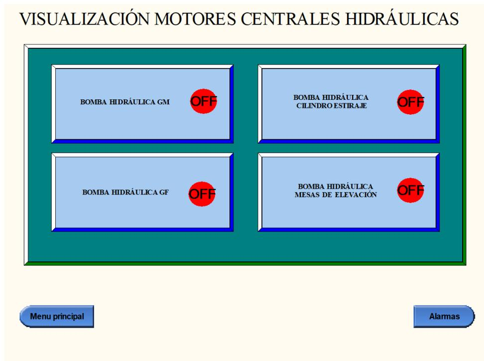
Figura 3.47: Interacción hombre/máquina desde HMI, visualización de funcionamiento bombas hidráulicas
