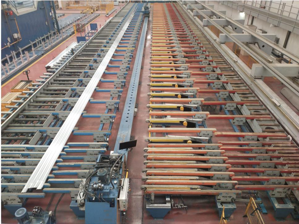
**Figura 3.5:** Línea de estirado de perfiles del proyecto
