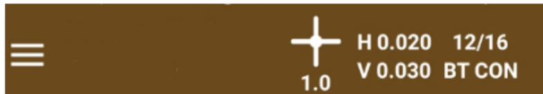
Figura 10. Barra de estado en posición RTK Fijo y precisiones del orden de centímetros.
