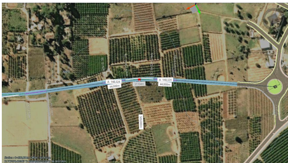
Figura 22. Transformación Espiral-Curva-Espiral en la segunda curva.
