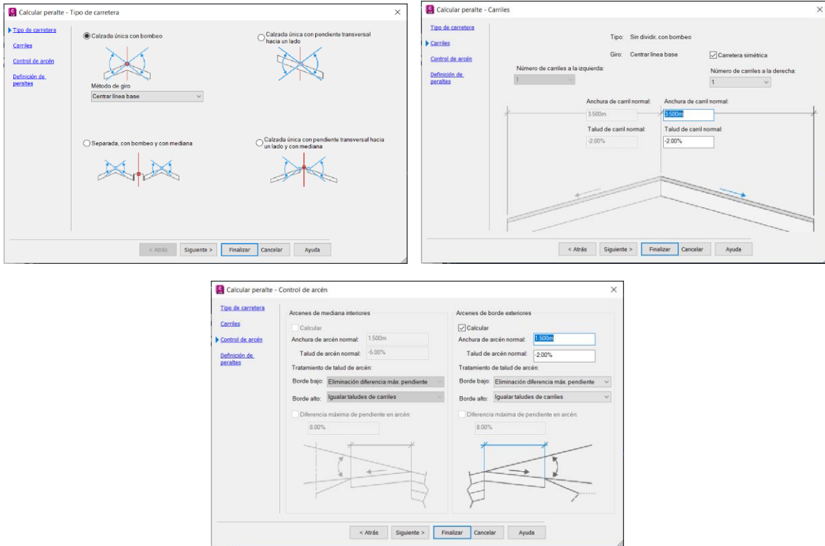
Figura 168. Configuración cálculo peralte.
