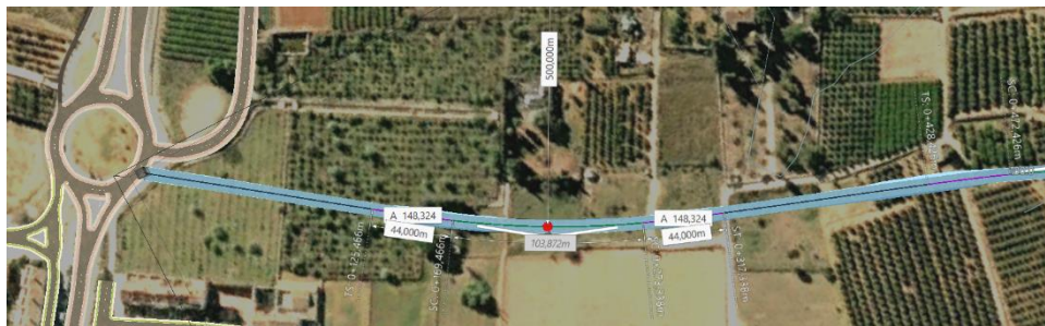
Figura 21. Transformación Espiral-Curva-Espiral en la primera curva.
