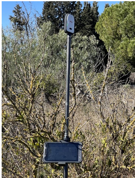
Figura 9. Antena Zeno FLX 100 emparejada con tablet y bastón de plomada.
