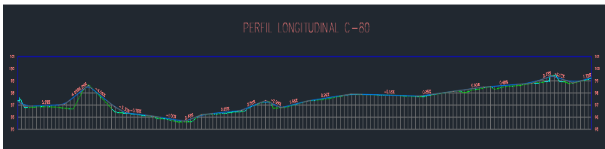
Figura 162. Perfil longitudinal con rasante ajustada al terreno.
