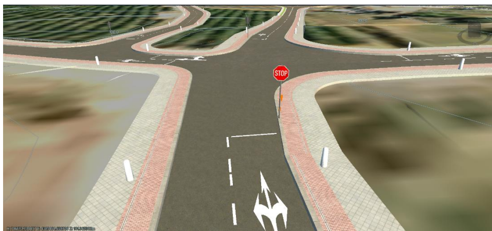
Figura 48. Intersección carretera frente al segundo tramo señalizada mediante "STOP".
