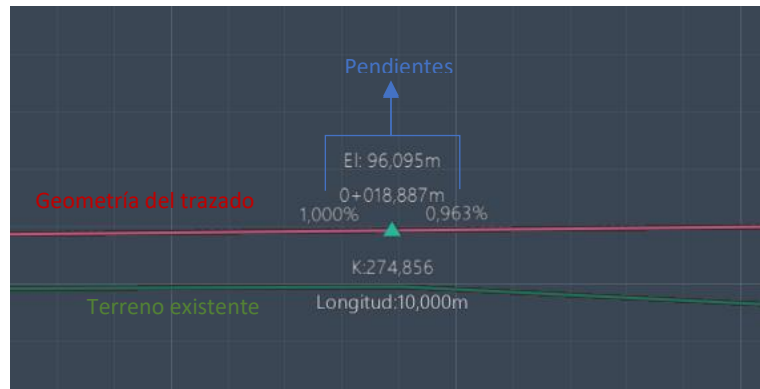
Figura 32. Explicación de la visualización del acuerdo vertical.
