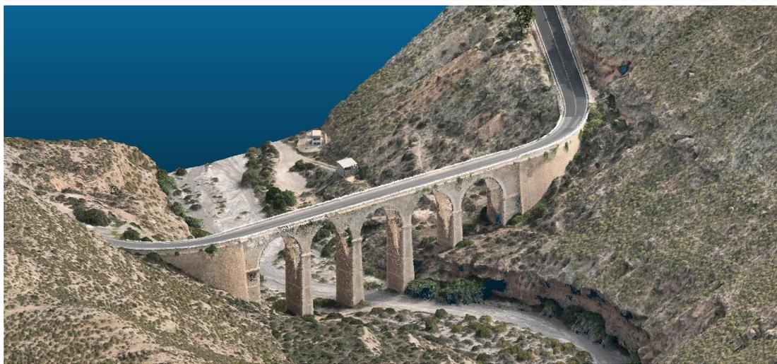
*Figura 14: Nube de puntos con puente – Fuente: Elaboración propia*
