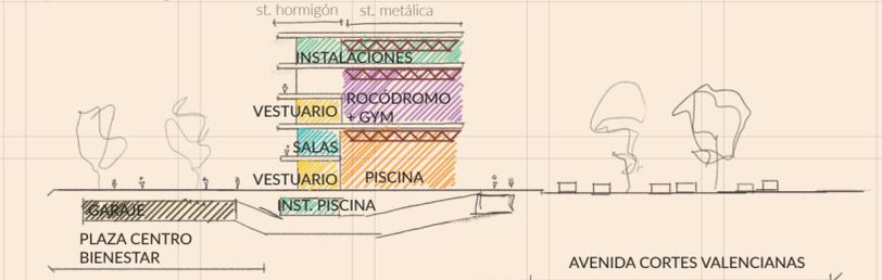
Esquema sección transversal. Usos y estructura.
