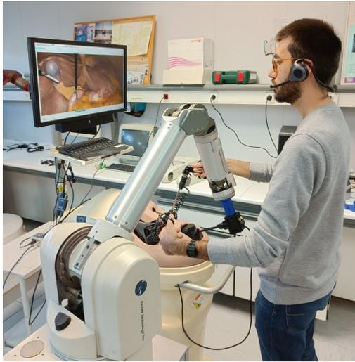
Figura 10: Fotografía de un operario utilizando el simulador y dando órdenes de movimiento a la cámara mediante comandos de voz.
