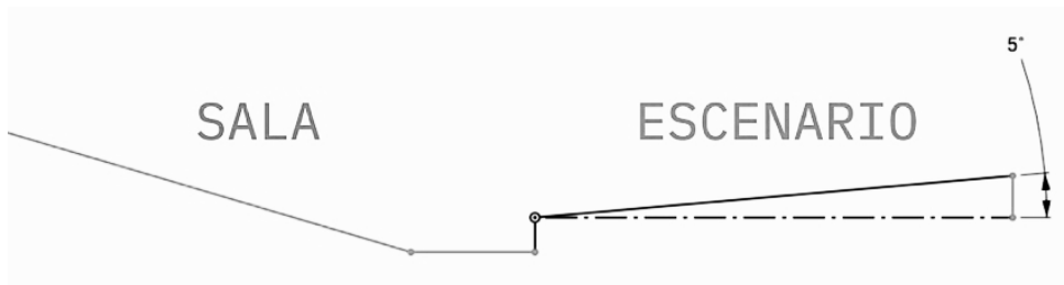
FIGURA 076. Gráfico de inclinaciones normativas de sala-escenario [Elaboración propia]
