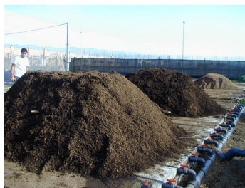
(a) Pilas con aireación por inyección
