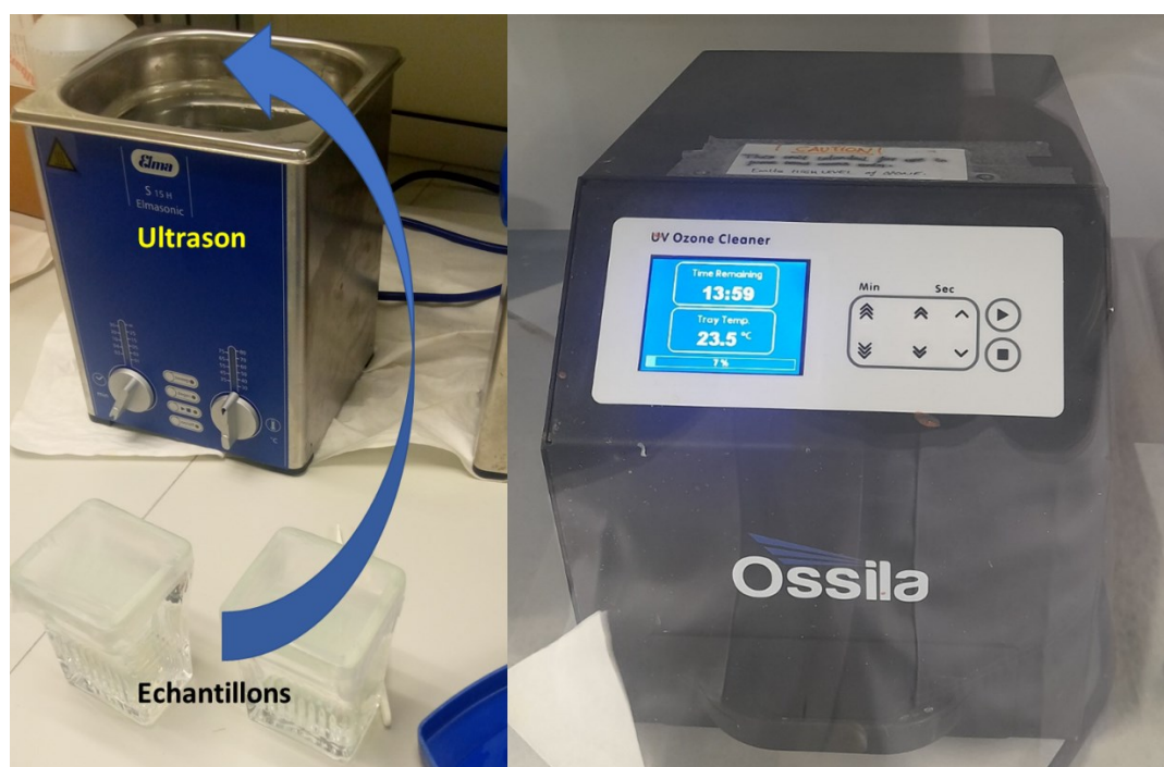
Figure III-1: Images de l'ultrason et de l'ossila utilisés pour le traitement des substrats.
