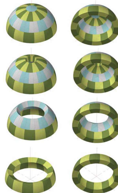
Ilustración 90. Secuencia constructiva. Visualización superior e inferior. García Jara, Francisco. La estereotomía de la cúpula semiesférica. UA, 2016.
