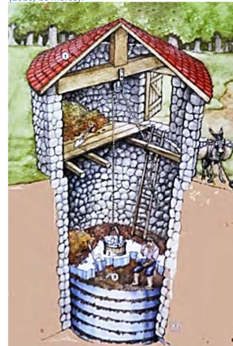
Ilustración 52. Refrigeración pozo de nieve | Frío Industrial, L. Montuori, L. (2020, 10 marzo).
