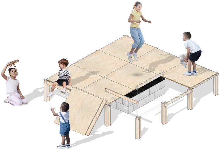
Figura 20. Representación de la plataforma de bloques de hormigón con el escenario Fuente: Elaborado por el autor
