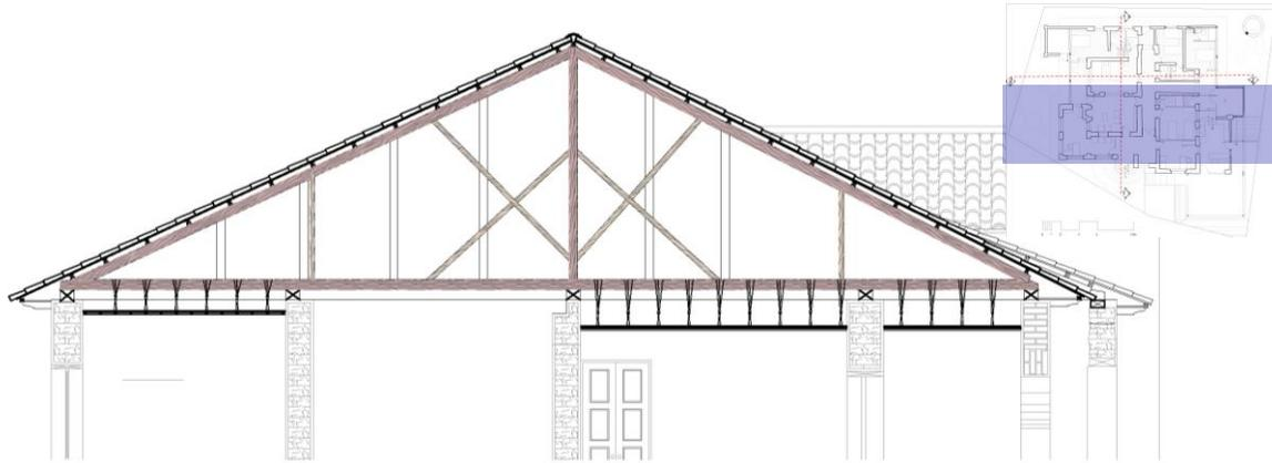
Ilustración 68 Cubierta de madera vista en corte transversal Fuente: Elaboración propia
