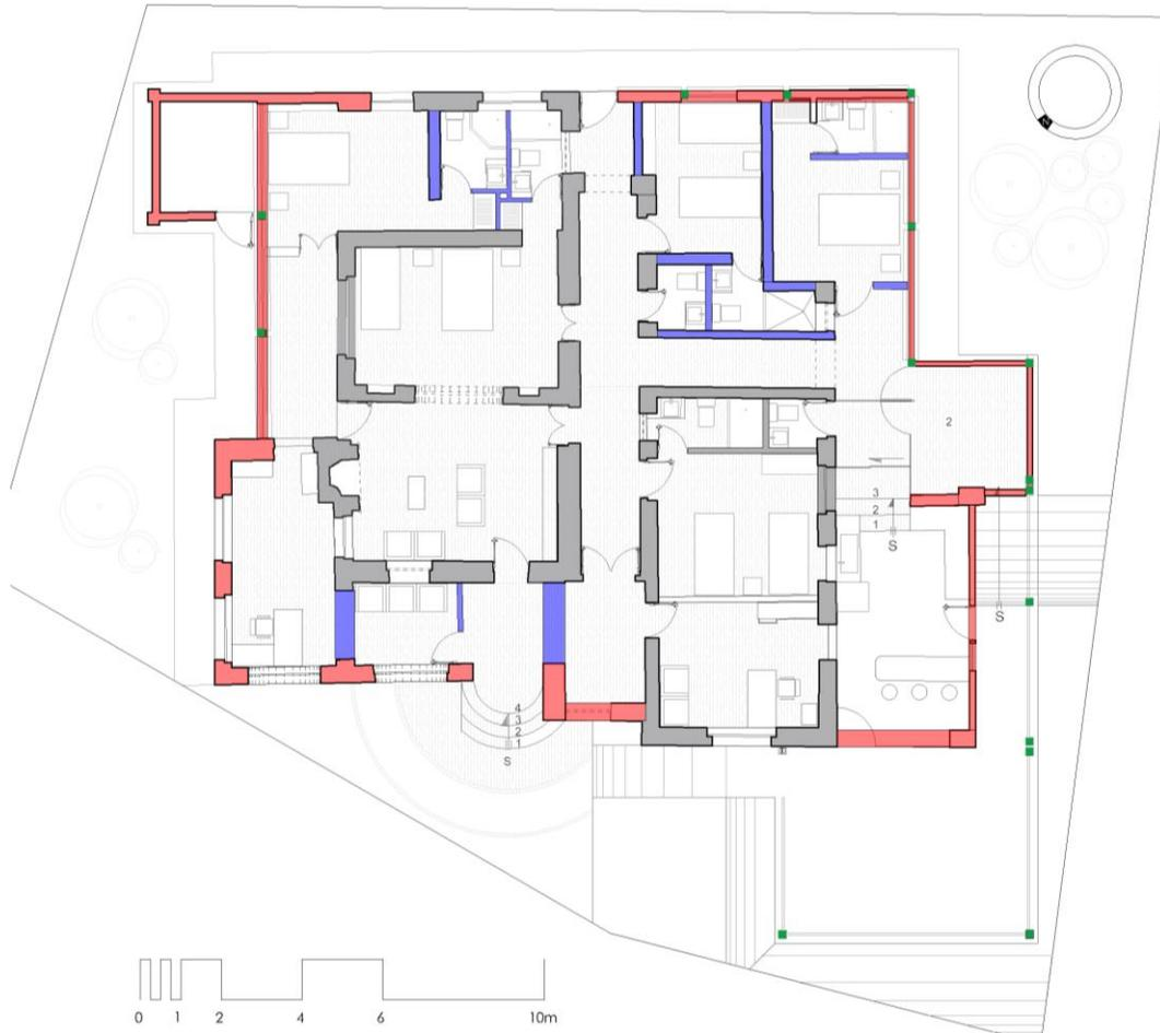
El sistema constructivo utilizado es el sistema portante estructural, con muros de 44 cm de ancho, de adobe que se asientan en cimentación de piedra- Ello se encuentra principalmente en los bloques A y B de la etapa original. La colocación del aparejo de los adobes corresponde a un sistema mixto, entre sogá y tizón, esto para lograr tener el espesor establecido.
