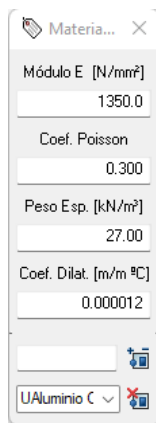
Figura 6-9. Propiedades mecánicas de los paneles de aluminio.
