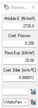
Figura 6-8. Propiedades mecánicas de los paneles de vidrio.
