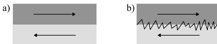
**Figura I.8.2.** Esquema de la teoría de los mecanismos de adhesión: a) superficie lisa y b) superficie rugosa.
