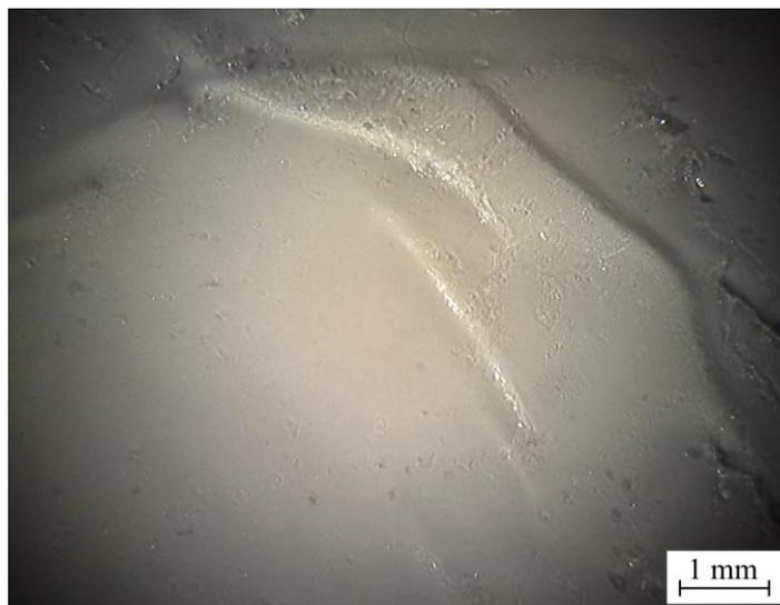
**Figura IV.4.11.** Detalle de la zona de adhesión tras el ensayo de la muestra de BioHDPE/5PC/PE-g-MA tratado con plasma atmosférico a una distancia de 5 mm.
