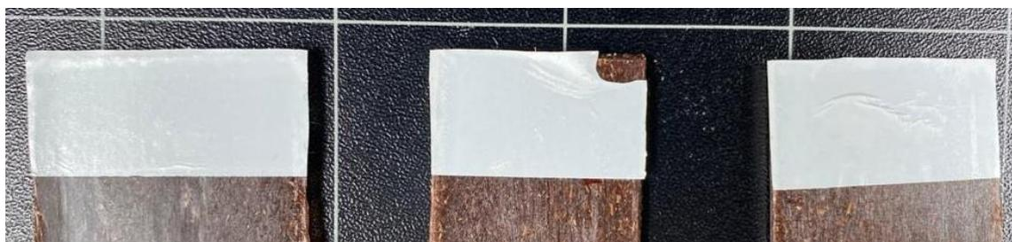
**Figura IV.4.17.** Fotografía de la zona de adhesión tras el ensayo en las muestras de BioHDPE/20PC/PE-g-MA: a) sin tratamiento; b) con tratamiento con plasma a una distancia de 5 mm; c) con tratamiento con plasma a una distancia de 10 mm.
