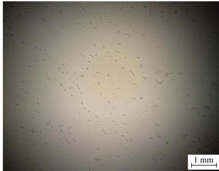
**Figura IV.4.6.** Detalle de la zona de adhesión tras el ensayo de la muestra de BioHDPE sin tratamiento con plasma atmosférico.
