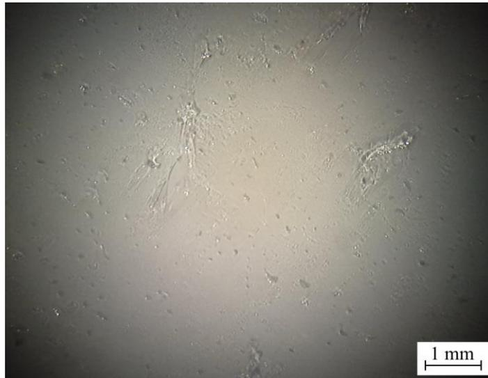
**Figura IV.4.20.** Detalle de la zona de adhesión tras el ensayo de la muestra de BioHDPE/20PC/PE-g-MA tratado con plasma atmosférico a una distancia de 10 mm.
