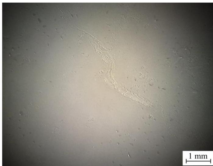
**Figura IV.4.16.** Detalle de la zona de adhesión tras el ensayo de la muestra de BioHDPE/10PC/PE-g-MA tratado con plasma atmosférico a una distancia de 10 mm.
