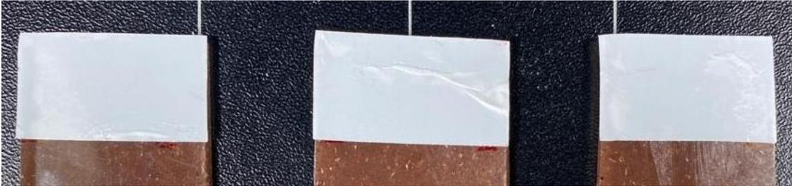
**Figura IV.4.9.** Fotografía de la zona de adhesión tras el ensayo en las muestras de BioHDPE/5PC/PE-g-MA: a) sin tratamiento; b) con tratamiento con plasma a una distancia de 5 mm; c) con tratamiento con plasma a una distancia de 10 mm.
