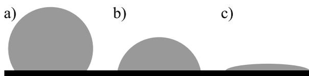
**Figura I.8.3.** Geometría de una gota en función de la humectación, a) baja humectación, b) intermedia y c) alta humectación.
