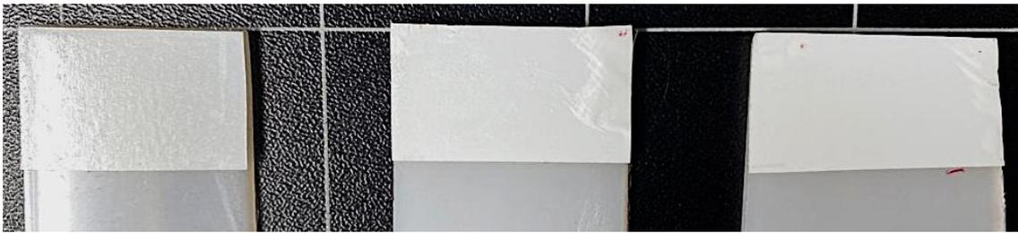
**Figura IV.4.5.** Fotografía de la zona de adhesión tras el ensayo en las muestras de BioHDPE: a) sin tratamiento; b) con tratamiento con plasma a una distancia de 5 mm; c) con tratamiento con plasma a una distancia de 10 mm.
