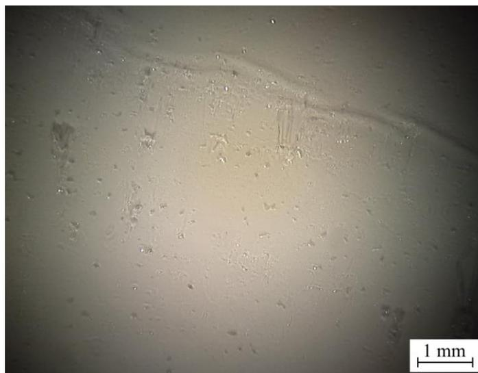
**Figura IV.4.7.** Detalle de la zona de adhesión tras el ensayo de la muestra de BioHDPE tratado con plasma atmosférico a una distancia de 5 mm.
