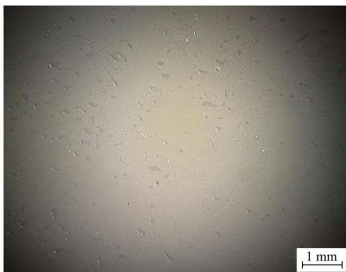
**Figura IV.4.8.** Detalle de la zona de adhesión tras el ensayo de la muestra de BioHDPE tratado con plasma atmosférico a una distancia de 10 mm.
