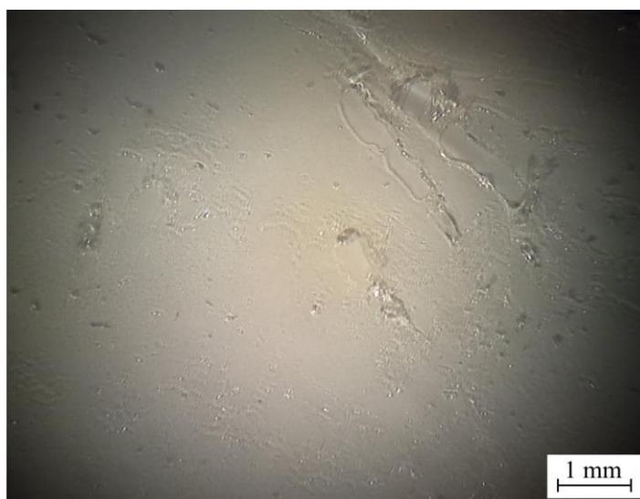
**Figura IV.4.12.** Detalle de la zona de adhesión tras el ensayo de la muestra de BioHDPE/5PC/PE-g-MA tratado con plasma atmosférico a una distancia de 10 mm.
