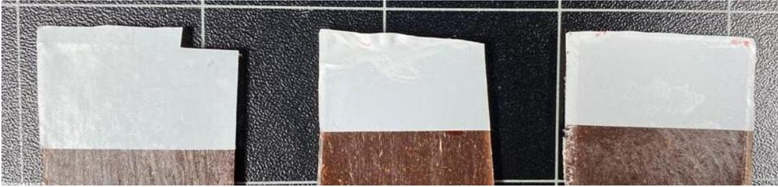
**Figura IV.4.13.** Fotografía de la zona de adhesión tras el ensayo en las muestras de BioHDPE/10PC/PE-g-MA: a) sin tratamiento; b) con tratamiento con plasma a una distancia de 5 mm; c) con tratamiento con plasma a una distancia de 10 mm.
