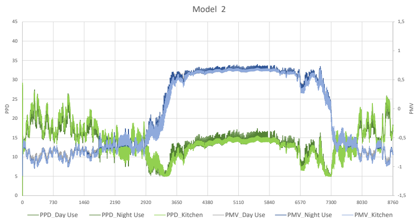
Figura 6. Valores de PPD y PMV para el Modelo B en diferentes zonas (cocina, uso diurno y nocturno) caso de estudio nº 1.
