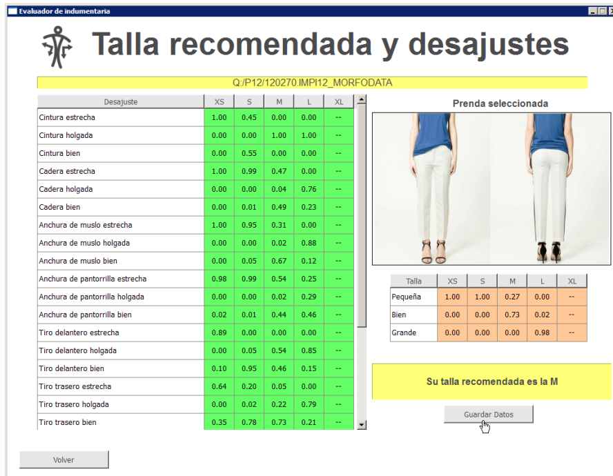
Figura 97. Implementación software que muestra el cálculo de probabilidades de que la prenda sea estrecha, adecuada o ancha por zonas y por cada talla.
