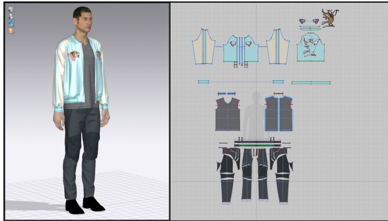
Figura 14. Simulación de la prenda en 3D a partir del patronaje 2D (Nivetha Sundar, 2017).
