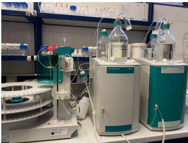
**Figura 16. Cromatógrafo iónico utilizado con sus dos columnas. La columna de la izquierda es la catiónica y la de la derecha la aniónica.**
