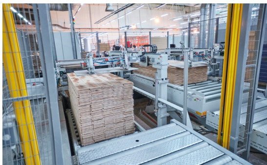
Figura 3.47. Sistemas de transferencia mediante mesa elevadora. Extraído de iStock.com , de 4maksym. Id: 1316462367. (2021). Licencia Estándar.
