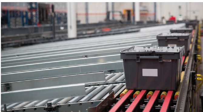
Figura 4.39. Transportadores de cadena en líneas paralelas para realizar operaciones de desvío ortogonal para la clasificación de mercancías. Extraído de iStock.com , de semaj29. Id: 185640646. (2013). Licencia Estándar.
