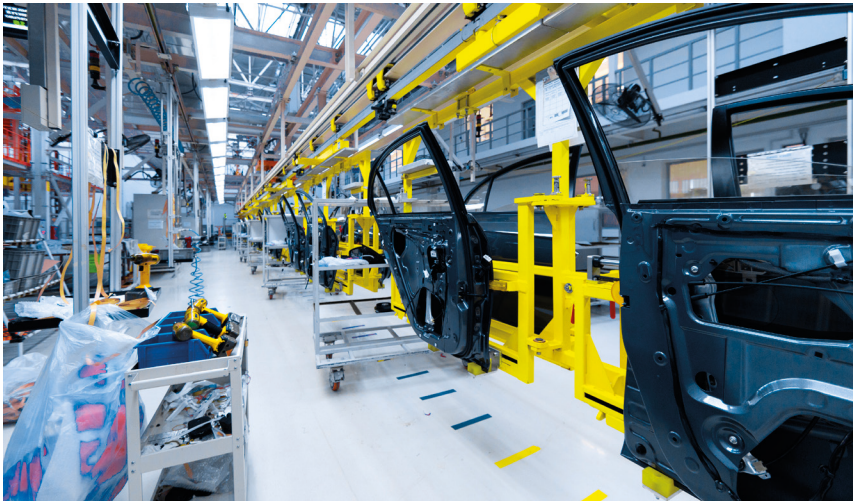
Figura 9.7. Transportador monorraíl eléctrico instalado en línea de ensamble de vehículos. Extraído de istock.com , de Traimak_Ivan Id: 1083495976. (2018). Licencia Estándar.
