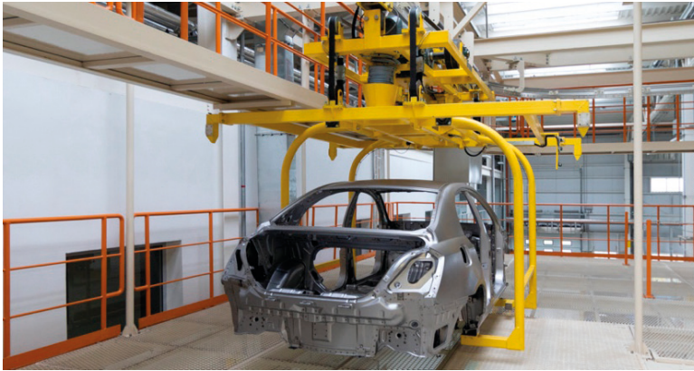
Figura 9.18. Instalación de transportador aéreo autopropulsado para el desplazamiento horizontal y vertical de piezas de gran volumen en procesos de montaje de automóviles. Extraído de istock.com , de Traimak_Ivan. Id: 066926844. (2018). Licencia Estándar.
