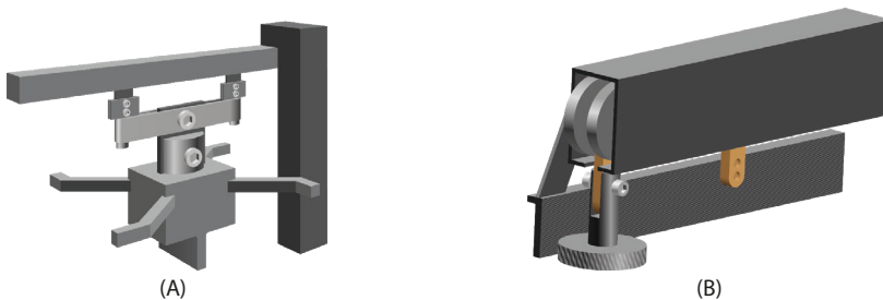
Figura 9.22. Accesorios especiales para el giro de piezas suspendidas en transportadores aéreos: (A) mecanismo de rotación automático que permite el posicionamiento de la pieza suspendida en cuatro orientaciones discretas, por ejemplo, para el tratamiento de las cuatro caras de una pieza suspendida; (B) mecanismo de rotación automático que permite la orientación en infinitas posiciones de la pieza a tratar mediante el giro continuo del utillaje de sujeción. Extraído y adaptado de Lindkvist, R.G.T. (1985). Handbook of Materials Handling . Ellis Horwood Ltd. England.
