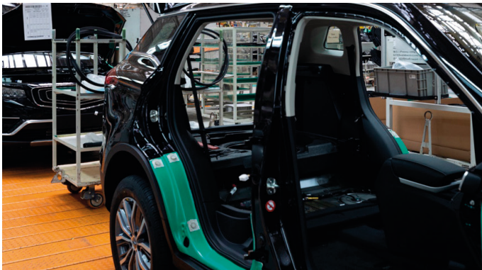
Figura 5.11. Transportador de tablillas instalado al nivel del suelo. Se usa en líneas para el ensamblado, inspección y ajuste final en el montaje de carrocerías. Extraído de iStock.com , de Traimak_Ivan. Id: 1370711983. (2022). Licencia Estándar.
