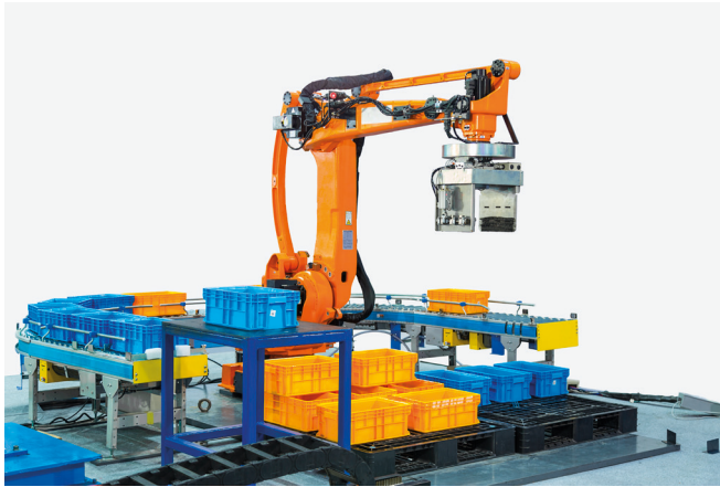
Figura 10.19. Ejemplos de un paletizador multiposición en el que la unidad de transferencia es el bulto. Extraído de iStock.com , de funfunphoto . Id: 921808546. (2018). Licencia Estándar.
