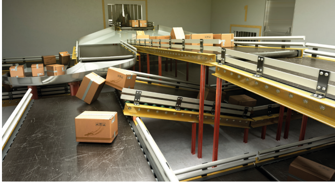
Figura 2.5. Ejemplo del uso de cintas transportadoras en la clasificación de mercancía variada en instalaciones de interior, mediante el uso de sistemas de desvío en curva, ortogonales y cambios de pendientes. Extraído de iStock.com , de NosUA. Id: 1180164058 (2019). Licencia estándar.
