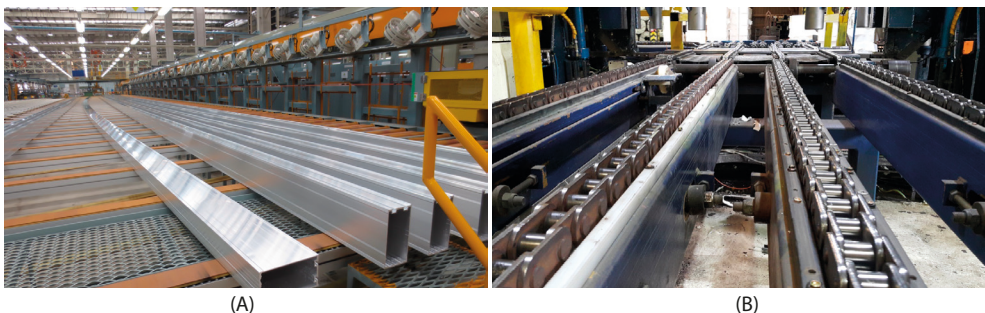
Figura 4.2. Transportador de cadenas para la manipulación de barras y piezas de gran longitud. (A) transporte de perfiles de aluminio de gran longitud con cadenas especiales. Extraído de iStock.com , de photoneyman. Id: 524202675. (2014). Licencia Estándar; (B) transporte con cadenas para cargas voluminosas y muy pesadas. Extraído de iStock.com , de khomsan rakphong. Id: 1152414441. (2019). Licencia Estándar.
