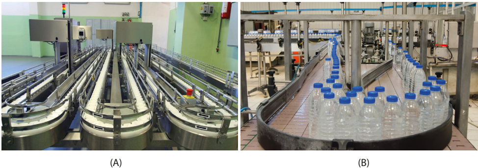
Figura 4.33. Ejemplos de cadena de plástico serpenteantes: (A) siguiendo trayectorias curvas. Extraído de iStock.com , de iZi947 . Id: 91075507. (2007). Licencia Estándar; (B) cadenas simples que pueden funcionar juntas y mover los ítems de una a otra por medio de guías. Extraído de iStock.com , de bariskaradeniz . Id: 466832106. (2015). Licencia Estándar.
