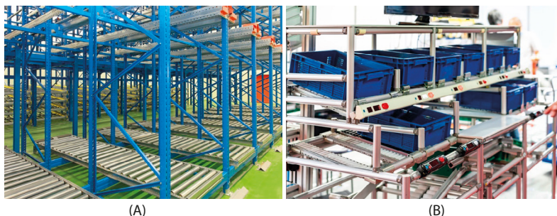
Figura 3.10. Ejemplos de líneas de transporte de rodillos sin accionamiento motriz en estanterías para almacenaje vivo: (A) en estanterías para el almacenamiento de palets. Extraído de iStock.com , de Baloncici Id: 463794355. (2014). Licencia Estándar; (B) en almacenamiento de cargas a granel en cajas de plástico. Extraído de iStock.com , de surasak patchang Id: 1315330450. (2021). Licencia Estándar.
