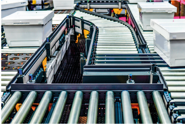
Figura 3.41. Combinación de sistemas de rodillos en secciones con redireccionamiento de mercancías. Extraído de iStock.com , de MJ_Prototype. Id: 1161080194. (2019). Licencia Estándar.
