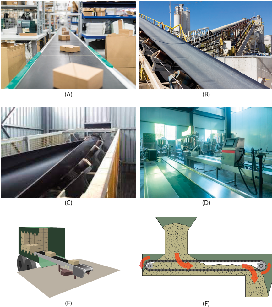
Figura 2.1. Tipologías de cintas transportadoras: (A) cinta plana horizontal con superficie lisa. Extraído de iStock.com , de Álvarez Id: 875013806 (2017). Licencia estándar; (B): cinta en artesa en pendiente ascendente. Extraído de iStock.com , JohnnyH5. Id: 519664519. (2014). Licencia estándar; (C): cinta tubular envolvente para materiales a granel con características especiales. Extraído de “Bandas Transportadoras”, de SAVA Slovenia. (2020). Licencia CC-BY-NC https://www.trelleborgslovenija.com/images/products-trans/catalogues/ESP-katalog_conveyor-belts_2020.pdf ; (D): cinta transportadora metálica. Extraído de iStock.com , de onlyyouqj. Id: 1415708249 (2022). Licencia estándar; (E) cinta telescópica portátil para la carga y descarga de vehículos; (F) cinta sumergida para graneles.
