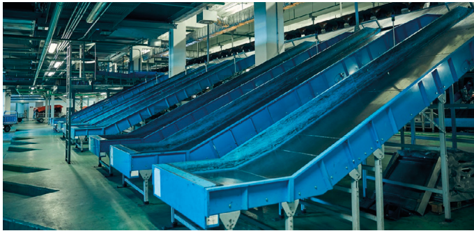
Figura 8.15. Instalación industrial con rampas lineales para el transporte de paquetería ligera. Extraído de iStock.com , de Svitlana Hulko Id: 1269570292. (2020). Licencia Estándar.
