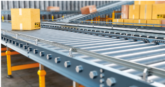
Figura 3.17. Rodillos accionados por una única cadena tangencial situada en la línea de transporte. Extraído de iStock.com , de urfinguss Id: 1400564667. (2022). Licencia Estándar.
