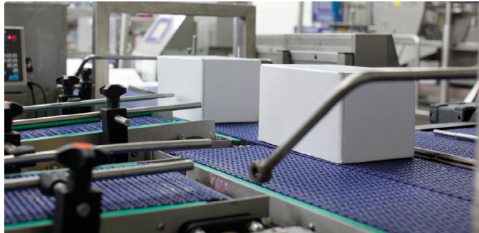
Figura 4.36. Transportadores de cadena de plástico en líneas paralelas para realizar operaciones de desvío y clasificación. Extraído de iStock.com , de endopack. Id: 486164611. (2014). Licencia Estándar.
