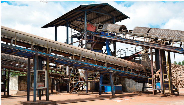
Figura 2.46. Dispositivos de protección exterior de cintas transportadoras para el transporte de cargas a granel: (A) sección transversal de la cinta carenada con mecanismo de apertura para mantenimiento; (B) ejemplo de uso de los sistemas de carenado en cintas exteriores para transportar material a granel. Extraído de iStock.com , de thaloengsak Id: 861486150. (2017). Licencia estándar.
