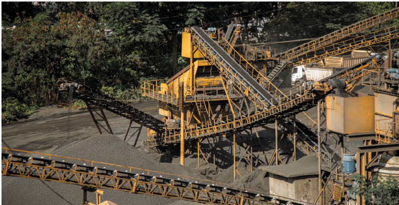
Figura 2.15. Ejemplos de bastidores de cintas para el transporte de materiales a granel montados sobre el suelo. Extraído de iStock.com , de Mailson Pignata Id: 1189414554. (2019). Licencia estándar.
