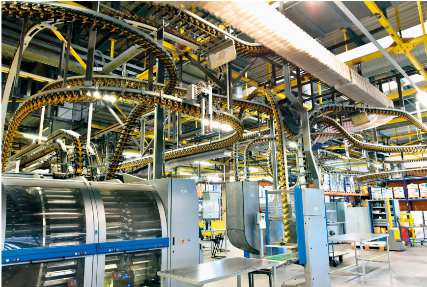
Figura 9.16. Instalación de transportador aéreo para la clasificación y transporte de periódicos y revistas en una gran imprenta. Extraído de istock.com , de industryview . Id: 1210538786. (2020). Licencia Estándar.
