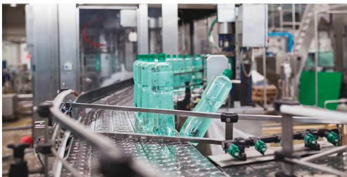
Figura 4.37. Transportadores de cadena en líneas paralelas para realizar operaciones de acumulación, desvío y clasificación. Extraído de iStock.com , de DuxX. Id: 652356058. (2017). Licencia Estándar.
