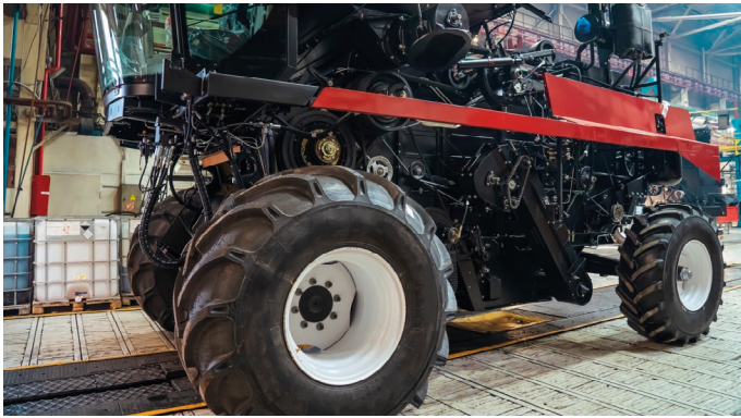
Figura 5.10. Transportador de tablillas de acero instalado en una línea de montaje de maquinaria agrícola pesada. Extraído de iStock.com , de DedMityay. Id: 1407355267. (2022). Licencia Estándar.
