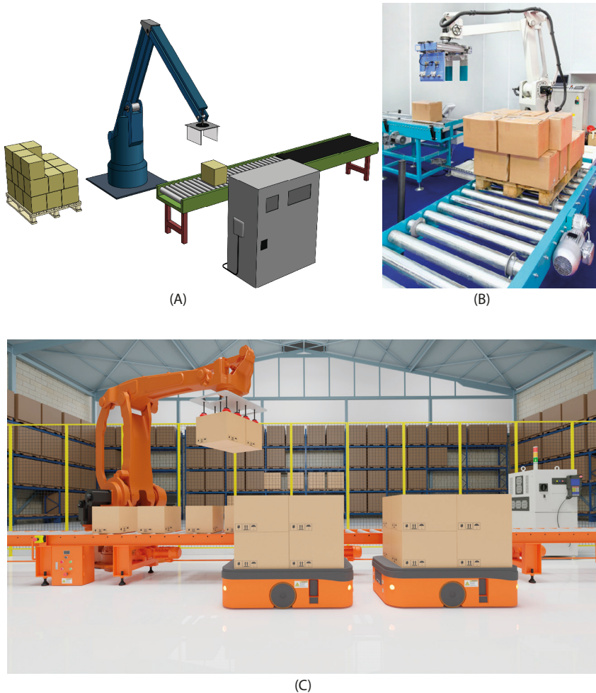
Figura 10.18. Ejemplos de un paletizador monoposición en el que la unidad de transferencia es el bulto: (A) palet monoposición con unidades de transferencia consistente en bultos individuales. Extraído y adaptado de Lindkvist, R.G.T. (1985). Handbook of Materials Handling. Ellis Horwood Ltd. England; (B) palet monoposición con unidades de transferencia consistentes en bultos individuales. Extraído de iStock.com , de Baloncici. Id: 512009623. (2014). Licencia Estándar; (C) paletizador monoposición con unidades de transferencia consistentes en líneas de la capa del palet configurado. Extraído de iStock.com , de IchigoRider. Id: 1420283160. (2022). Licencia Estándar.
