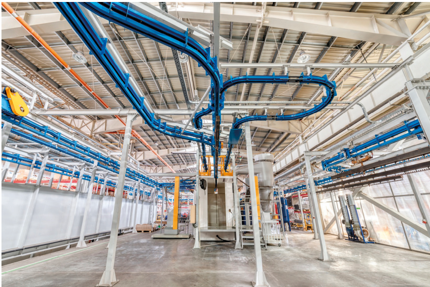
Figura 9.17. Instalación de transportador aéreo de cadena independiente para el tratamiento térmico de piezas en cabinas de secado. Extraído de istock.com , de Nordroden. Id: 1097890554. (2019). Licencia Estándar.
