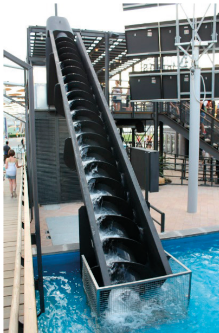
Figura 6.1. Tornillo de Arquímedes. Extraído de "Expo" (2008), de Fernando, Flickr. Licencia CC BY-SA 2.0.
