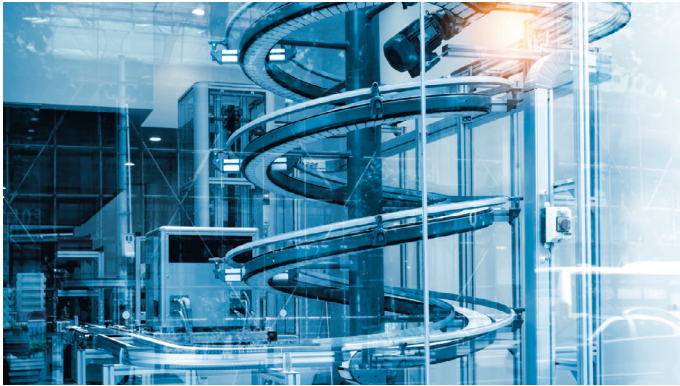
Figura 4.38. Transportadores de cadena para realizar operaciones de transporte vertical en toboganes. Extraído de iStock.com , de Zapp2Photo. Id: 819305486. (2017). Licencia Estándar.
