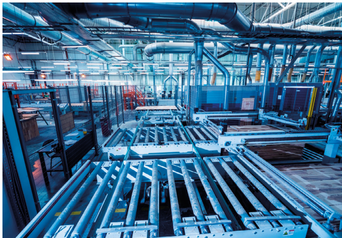
Figura 3.48. Ejemplo de sistemas de transferencia en los que la línea principal es la línea de cadenas en la producción de suelos de madera. Extraído de iStock.com , de romaset. Id: 1184984637. (2019). Licencia Estándar.
