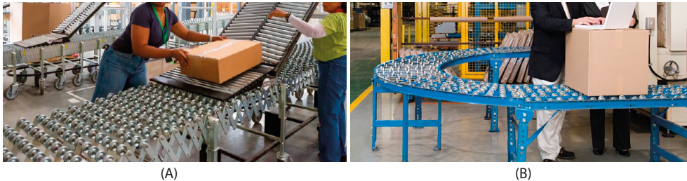
Figura 3.61. Transportador por ruedas móvil y extensible: (A) en línea recta. Extraído de iStock.com , de halbergman. Id: 1351437853. (2021). Licencia Estándar; (B) en curva. Extraído de iStock.com , de Image source. Id: 72737536. (2013). Licencia Estándar.
