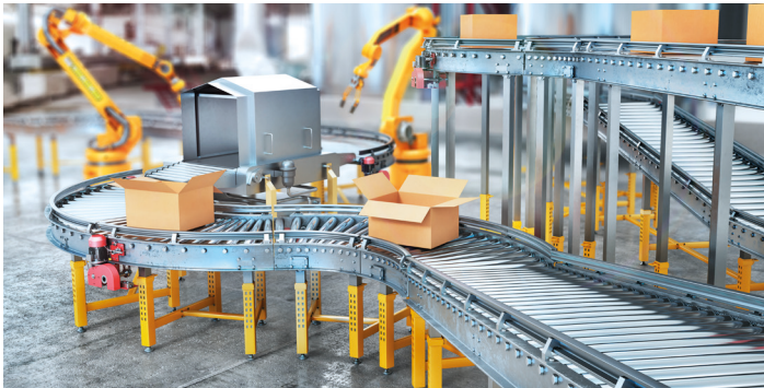
Figura 1.1. Ejemplo de línea restringida en un sistema de transporte continuo de mercancías basado en líneas de rodillos. Extraído de iStock.com , de Urfinguss Id: 1162340507. (2019). Licencia estándar.
