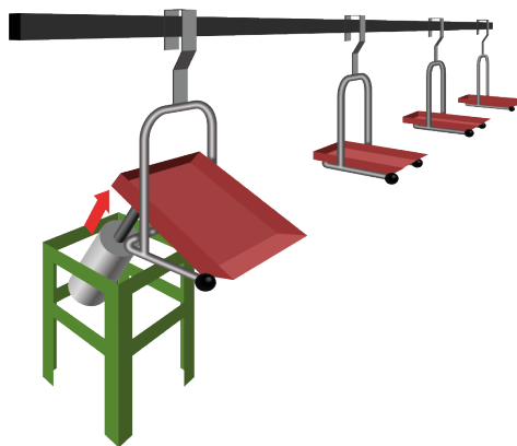
Figura 9.23. Operación de descarga por medio de la inclinación de los carros transportadores de la carga. Extraído y adaptado de Lindkvist, R.G.T. (1985). Handbook of Materials Handling . Ellis Horwood Ltd. England.
