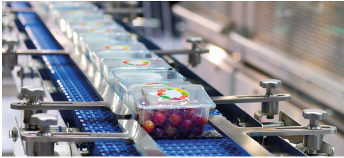
Figura 4.35. Con transportadores de cadena de plástico simple se puede mover los ítems de una a otra por medio de guías. Extraído de iStock.com , de MJ_Prototype. Id: 1061675814. (2018). Licencia Estándar.
