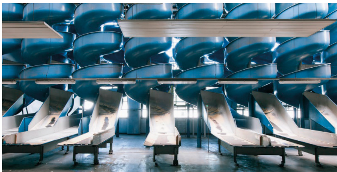
Figura 8.16. Rampa en espiral de una terminal de carga utilizada para desplazar mercancías de un nivel superior (selección) a un nivel inferior (entrega). Extraído de "POSTCITY" (2015), de Ars Electrónica. Flickr.com . Licencia Atribución-No Comercial-Sin derivados (CC BY-NC-ND 2.0).
