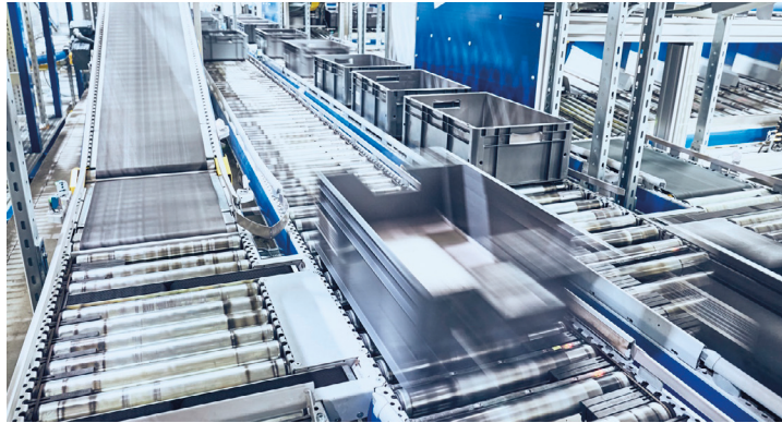
Figura 2.4. Ejemplo de combinación de cintas transportadoras en plano horizontal e inclinado con otros sistemas de transporte por rodillos para el transporte de cargas unitarias en cajas de plástico. Extraído de iStock.com , de MBPROJEKT_Maciej_Biedowski. Id: 1266941311 (2020). Licencia estándar.
