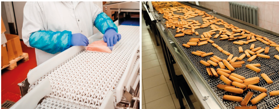
Figura 2.13. Ejemplos del uso de cintas transportadoras en malla para el transporte de cargas con condiciones especiales: (A) con malla de plástico para industria cárnica. Extraído de iStock.com , de Maksymenko Natalila Id: 1384673497. (2022). Licencia estándar; (B) con malla de acero en industria confitera. Extraído de iStock.com , de Vital Hil Id: 1420496535. (2022). Licencia estándar.
