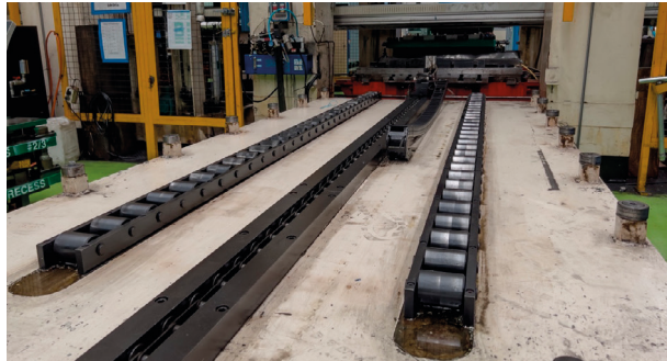
Figura 3.57. Ejemplo de transportador por ruedas con largueros en paralelo para el desplazamiento de cargas pesadas. Extraído de iStock.com, de Ekkaluck. Id: 1405772881. (2022). Licencia Estándar.
