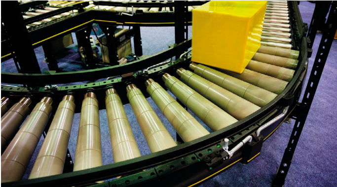
Figura 3.29. Curvas con rodillos divididos en dos o más partes. Extraído de iStock.com , de Supersmario. Id: 838254912. (2017). Licencia Estándar.
