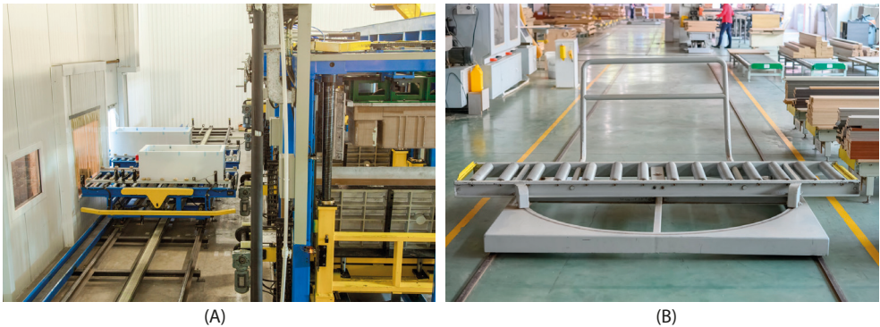
Figura 3.45. Sistemas de transferencia mediante carro: (A) con accionamiento motriz en el desplazamiento longitudinal del carro. Extraído de iStock.com , de Albert_Karimov. Id: 639460986. (2017). Licencia Estándar.; (B) con accionamiento manual del carro a lo largo del carril longitudinal. Extraído de iStock.com , de Freer Law. Id: 177591439. (2019). Licencia Estándar.
