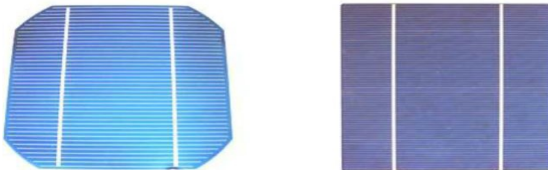
Figure I. 7: cellule monocristalline à gauche et poly-cristalline à droite [33].
