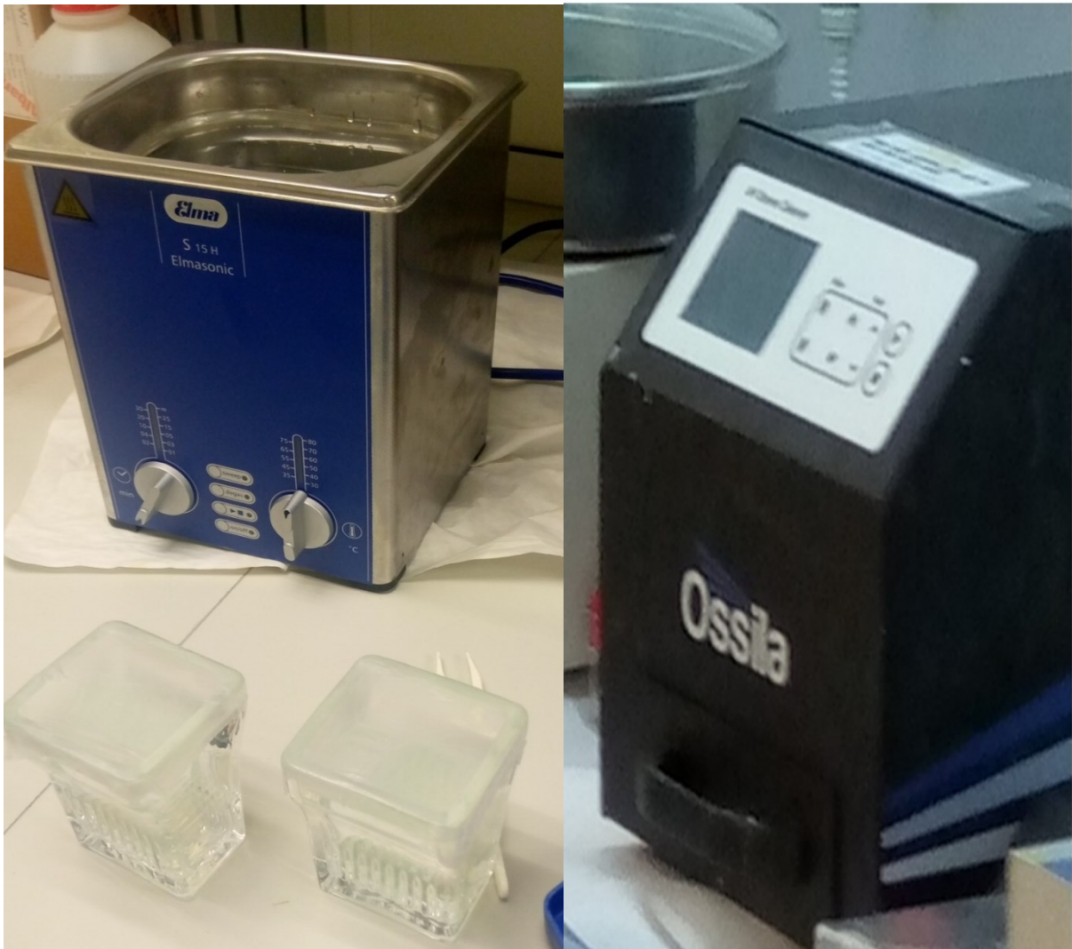
Figure III. 2: Présentation de l'appareil de l'ultrason et OSSILA.
