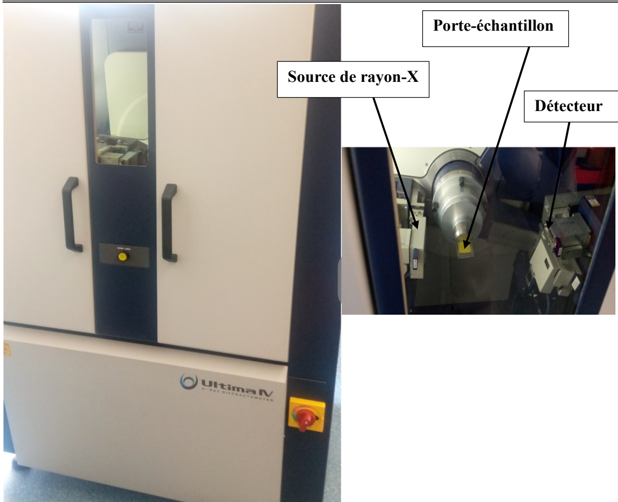
Figure III. 8: Le diffractomètre RIGAKU ULTIMA IV utilisé pour les diffractions des rayons-X.
