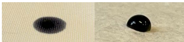
Figura 2. Gota de solución sobre tejido PES (izqda.). Gota de solución sobre papel celulósico (dcha.).
