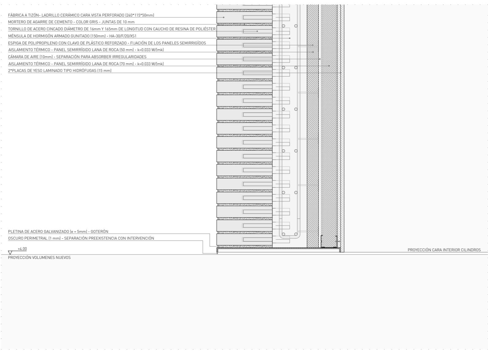
DET 03. VARIABLE DE "DET 07" QUAN SEMICILINDRE DE FÀBRICA DE RAJOLA CARAVISTA QUEDA VOLANT, GOTERO. NOUS ACABATS INTERIORS
