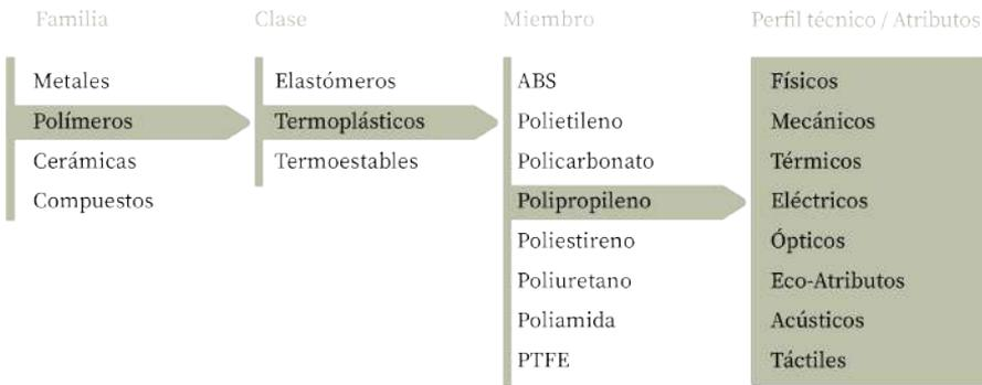
Figura 22. Adaptación del diagrama «Clasificación de Materiales», presentado por Ashby y Johnson en *Materials and Design* (2010), un libro pionero en la traducción de los conocimientos de la ciencia de los materiales para su mejor comprensión por parte de los diseñadores. En el diagrama observamos la clasificación de los materiales basados en su estructura atómica y electrónica.
