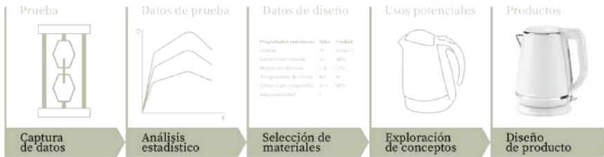
Figura 23. Adaptación del diagrama «Confianza en Nuevos Materiales», presentado por Ashby y Johnson en *Materials and Design*. En este diagrama, observamos los pasos que sigue un material, desde el laboratorio hasta el producto. En el tercer paso, «Selección de materiales», convergen la ciencia de los materiales y el diseño.
