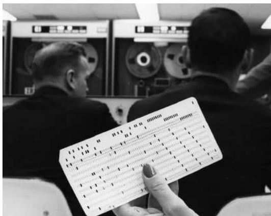
Figura 32. Las tarjetas perforadas se utilizaron desde la década de 1890 hasta finales de la década de 1970, como método de procesamiento de datos y almacenamiento. Estas tarjetas eran usadas para interactuar con las computadoras, configurando una interacción fundamentalmente material entre humano y computadora.
