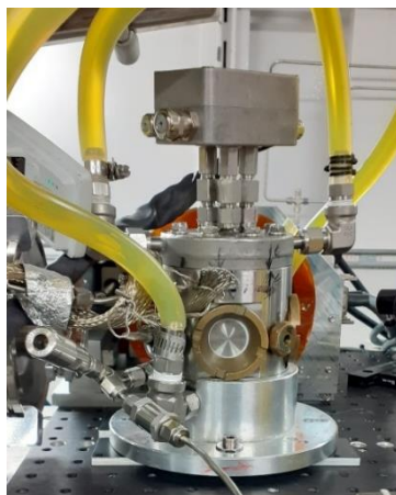
Figura 3.3. Imagen de la celda multiusos ITQ-ALBA empleada para registrar los espectros durante la pirólisis.
