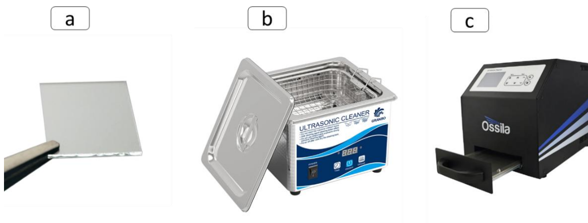
Figure 2.1 : (a) substrat en verre recouvert d'oxyde d'étain dopé au fluor (FTO). (b) L'ultrason, peut monter la température jusqu'à 70°C pour optimiser le nettoyage. (c) Appareil à UV-ozone
