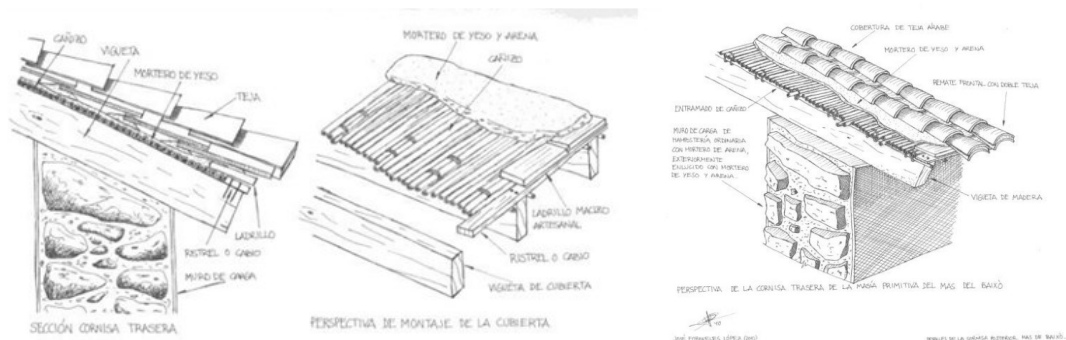
Imagen 3.12 Detalles constructivos construcción vernácula (Fornielles)
