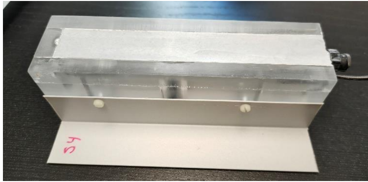
Figura 19. Sensor electroquímico de temperatura, potencial y velocidad de corrosión.
