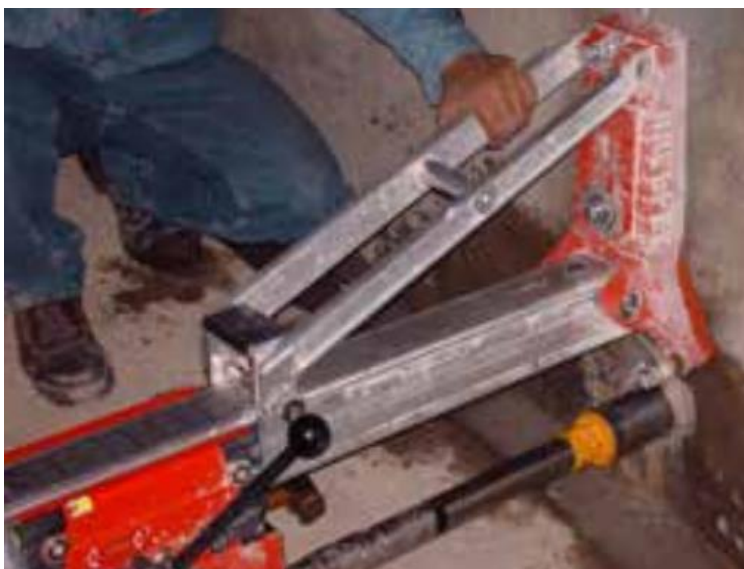
Figura 14. Extracción de testigos
