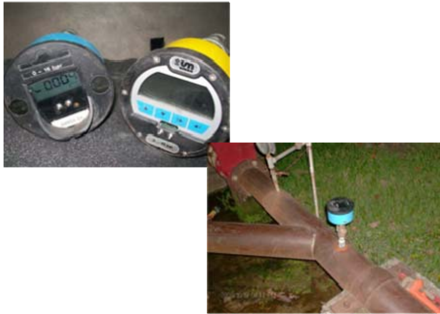
Figura N°35 Equipo registrador de presión.
