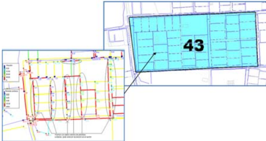
Figura N°56 Zona con altos valores de pérdidas unitarias en el sector 43
