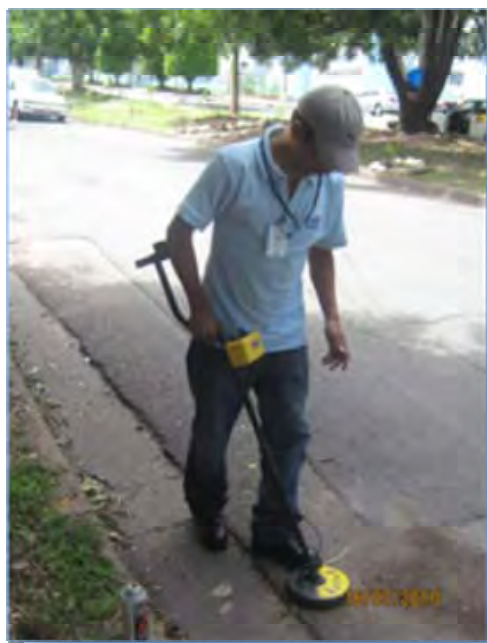
Figura N°12 Operario utilizando el equipo FT-80 para detección de tapas metálicas.
