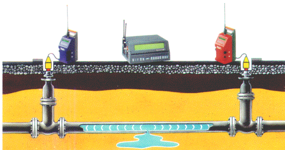
Figura 10. Principio de funcionamiento del correlador.
