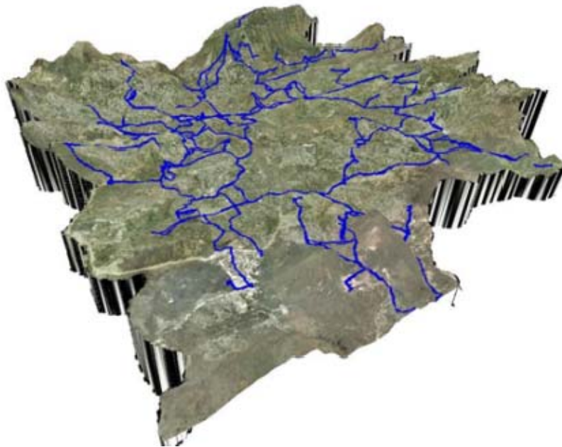
Figura N°30 Red de línea de alta sobre MDT.
