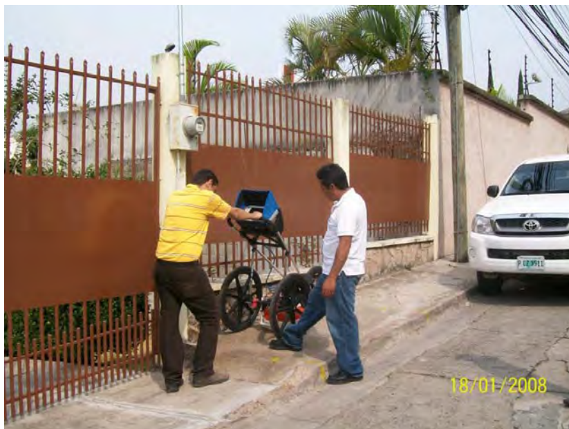
Figura 5. Ejemplo de trabajo en campo de una de las brigadas haciendo uso del georadar.
