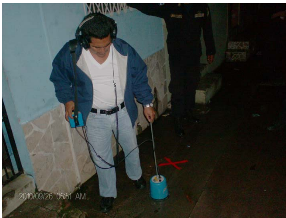
Figura 6. Ejemplo de trabajo en campo haciendo uso de Geófono (Jornada nocturna).
