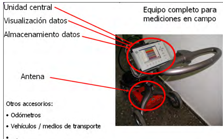
Figura 14. Radar de subsuelo con sus componentes.
