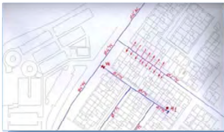
Figura N°23 Ejemplo de dibujo de acometidas en plano de campo
