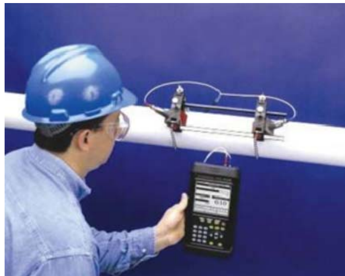
Figura N°34 Equipo registrador de caudal.
