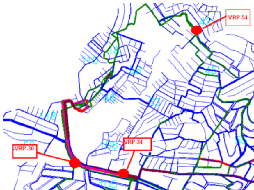
Figura N°65 Válvulas reguladoras de presión con mantenimiento requerido.
