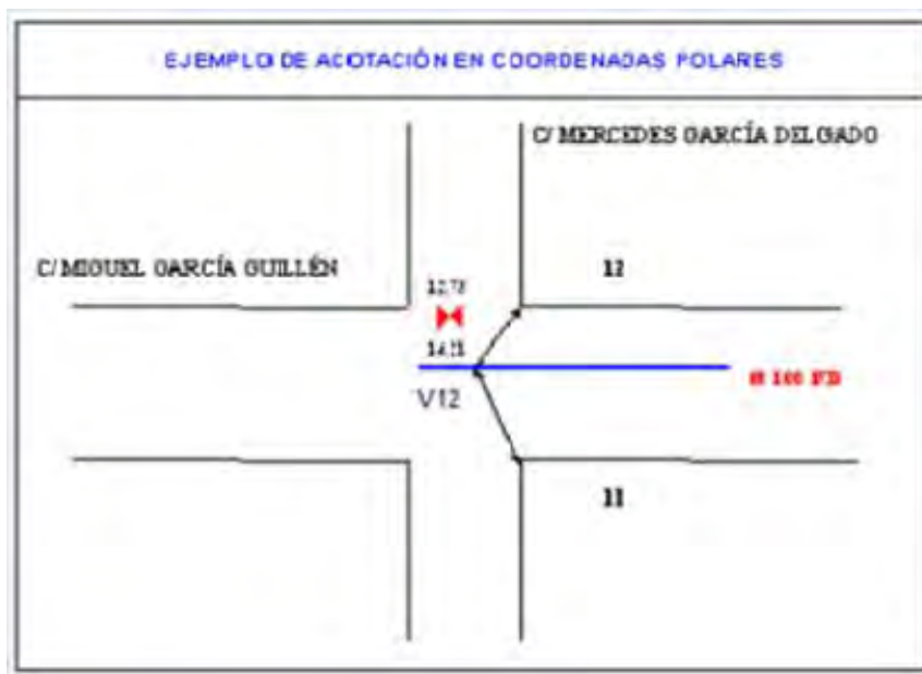
Figura N°21 Acotación en coordenadas polares
