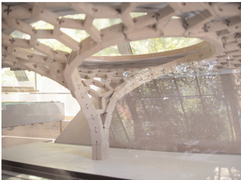
Fig. 246. Maqueta colgada e invertida de malla hexagonal para la estación de Stuttgart. Fuente: Foto del autor N° P6070016.
