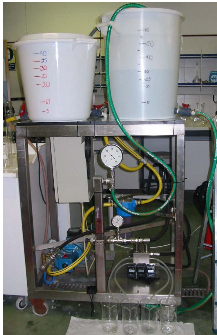
Fig. 3.8 Planta piloto empleada en los ensayos con limpiezas
