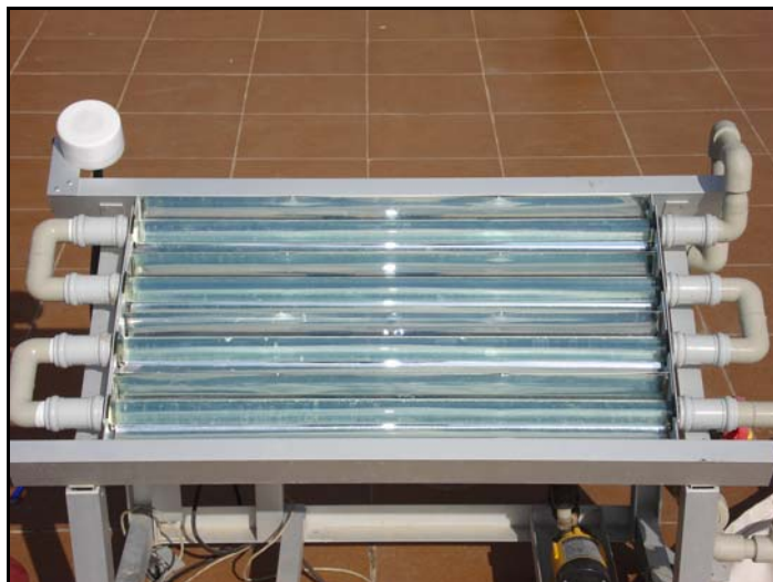
Figura 3.8. Planta piloto de fotocátalisis solar de 4 L.
