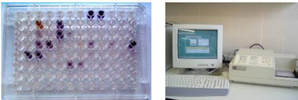
Figura 6: Izquierda: Microplaca GP2 donde se observan los pocillos positivos por la reducción del tetrazolio. Derecha: Equipo completo de MicroLog.
