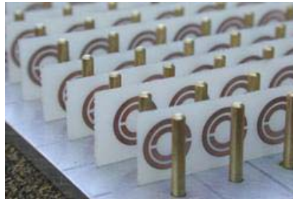
Fig. 2. Primer medio zurdo realizado combinando periódicamente postes metálicos y resonadores SRR [2].
